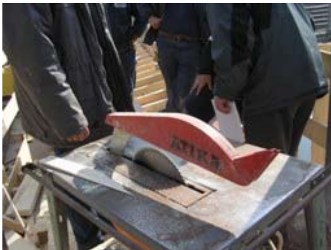
15. ábra. A védősisak ROSSZ beállítása
