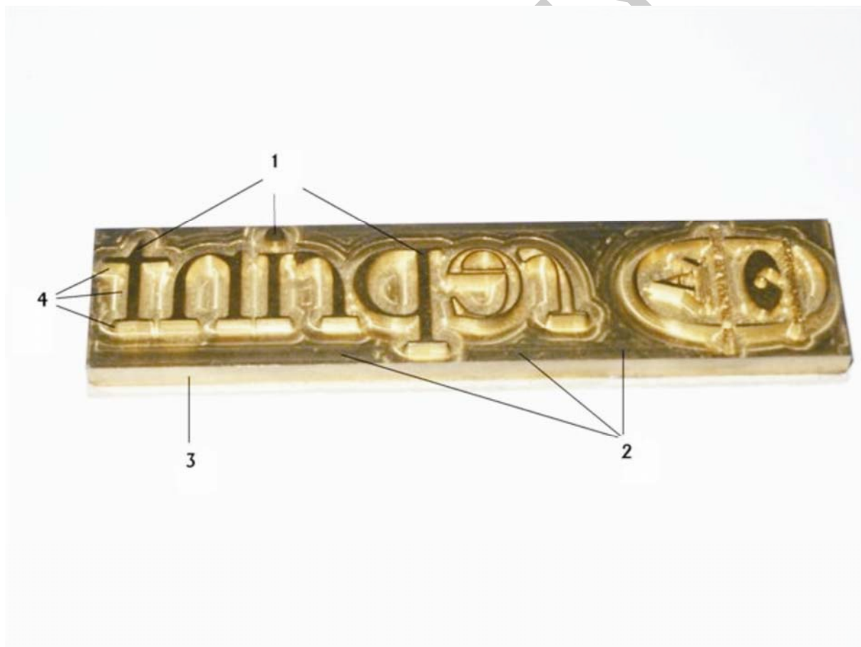
5. ábra. Vésnöki módszerrel előállított présaranyozás nyomóformája. 1. nyomóelem, 2. nemnyomó elem, 3. a réz vastagsága, 4. a nyomóelemek válla, vállának dőlésszöge
