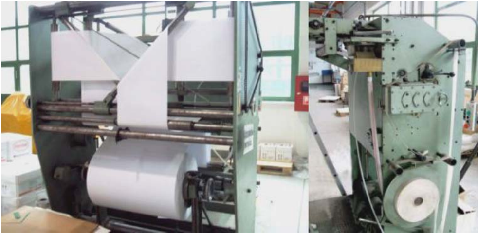
13. ábra. . Kombinált előzéket gyártó gép letekercselő és kenő műve
