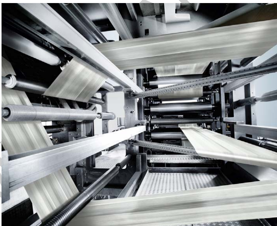
15. ábra. LITOMAN gép papírpálya vezetése és fordítása
