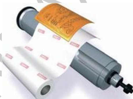
11. ábra. Nyomóforma felragasztása a formahengerre 11
