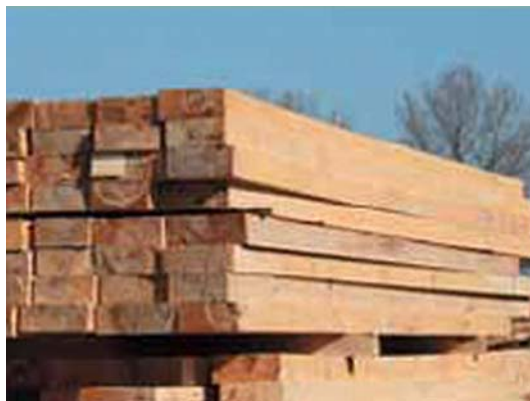
3. ábra. Tömör egység rakat, szélezett fenyő fűrészáruból 3
