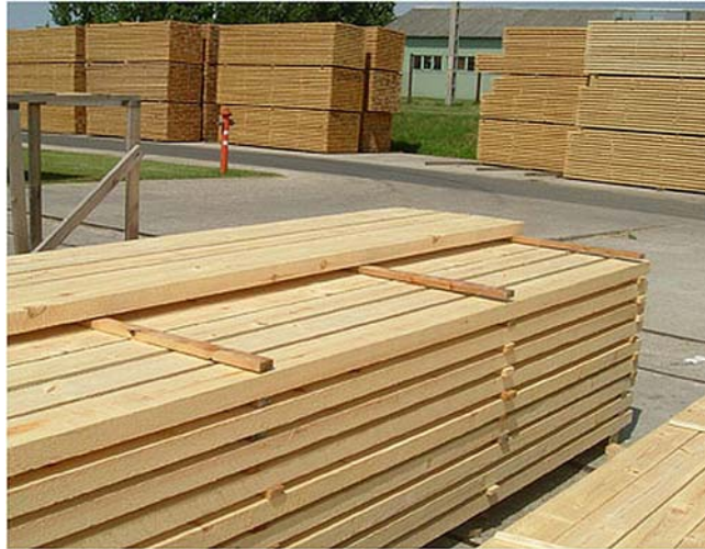
5. ábra. Hézaglécezett egységgrakat, szélezett fenyő fűrészáruból 5
