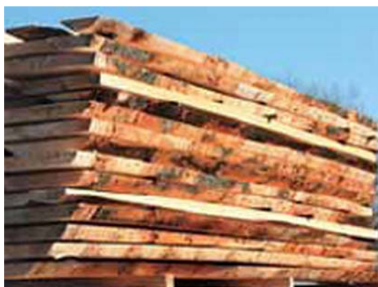
4. ábra. Hézaglécezett egység rakat, szélezetlen lombos fűrészáruból 4
