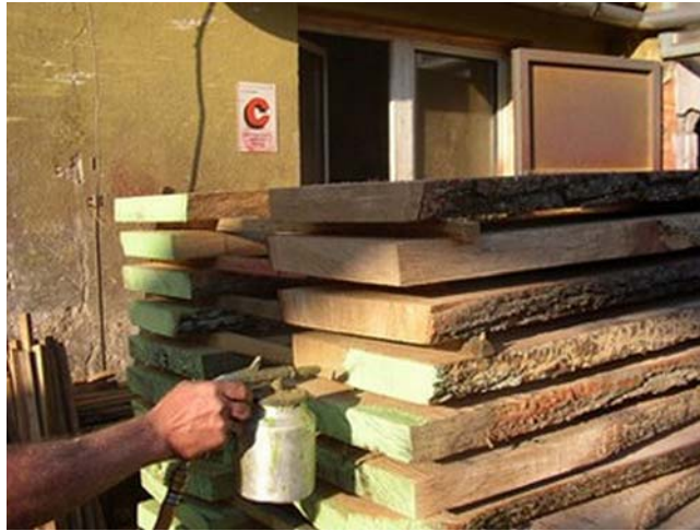
15. ábra. Fűrészáru bütüinek védelme paraffin emulzióval 15
