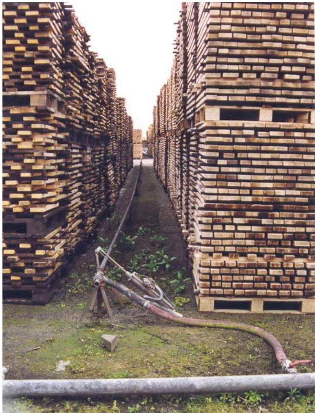
8. ábra. Borosdonga korszerű tárolása kiépített vízvezeték hálózattal
