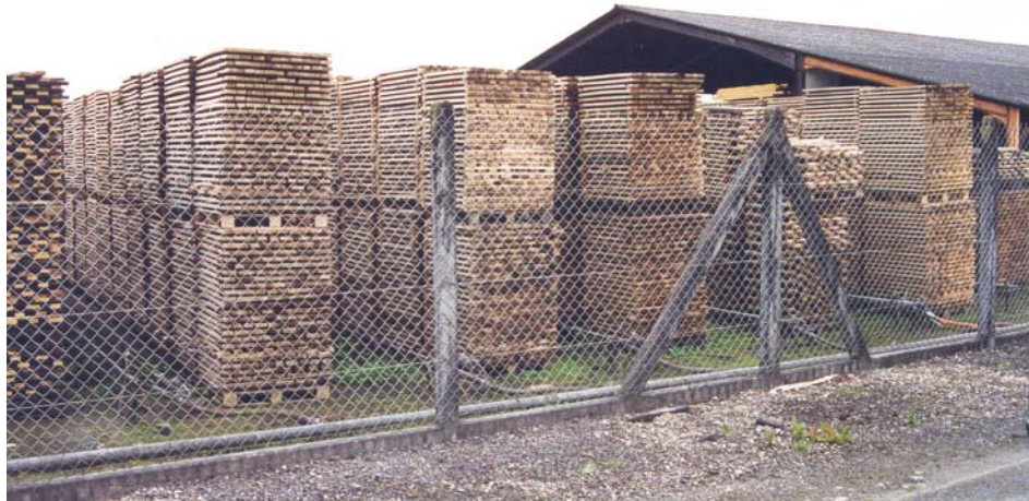
10. ábra. Tölgy borosdonga korszerű máglyázása
