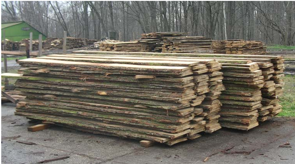
6. ábra. Tömör egységakat tölgy szélezetlen deszkából
