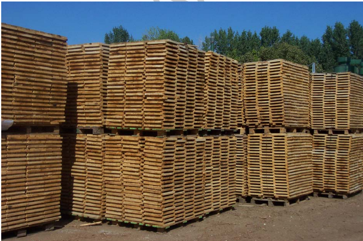
9. ábra. Rakodólapokon tárolt parkettaléc egységgrakatokból kialakított máglyák
