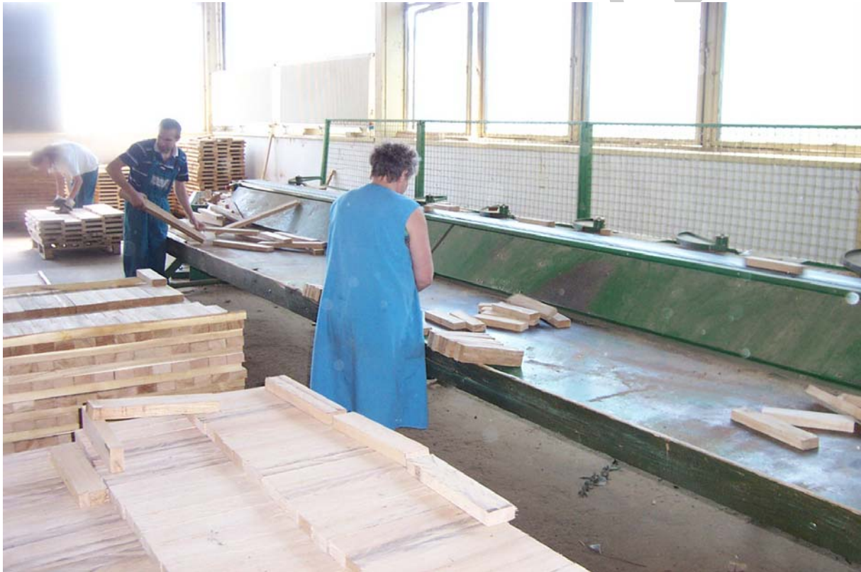
4. ábra. Parkettaléc minőségi osztályozása hosszosztályozó gép mellett
