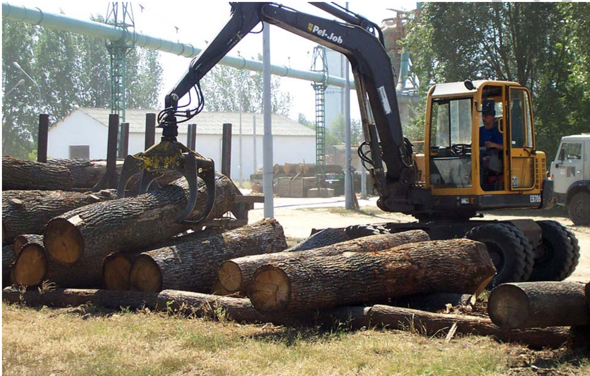
5. ábra. Rönkosztályozás mobil rakodógéppel
