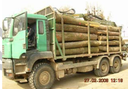
1. ábra. Rönk beszállítása a fűrészüzembe saját daruval felszerelt tehergépkocsin
