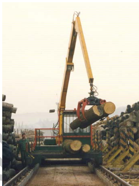
2. ábra. Sínen mozgó darus kocsí rönkosztályozás közben
