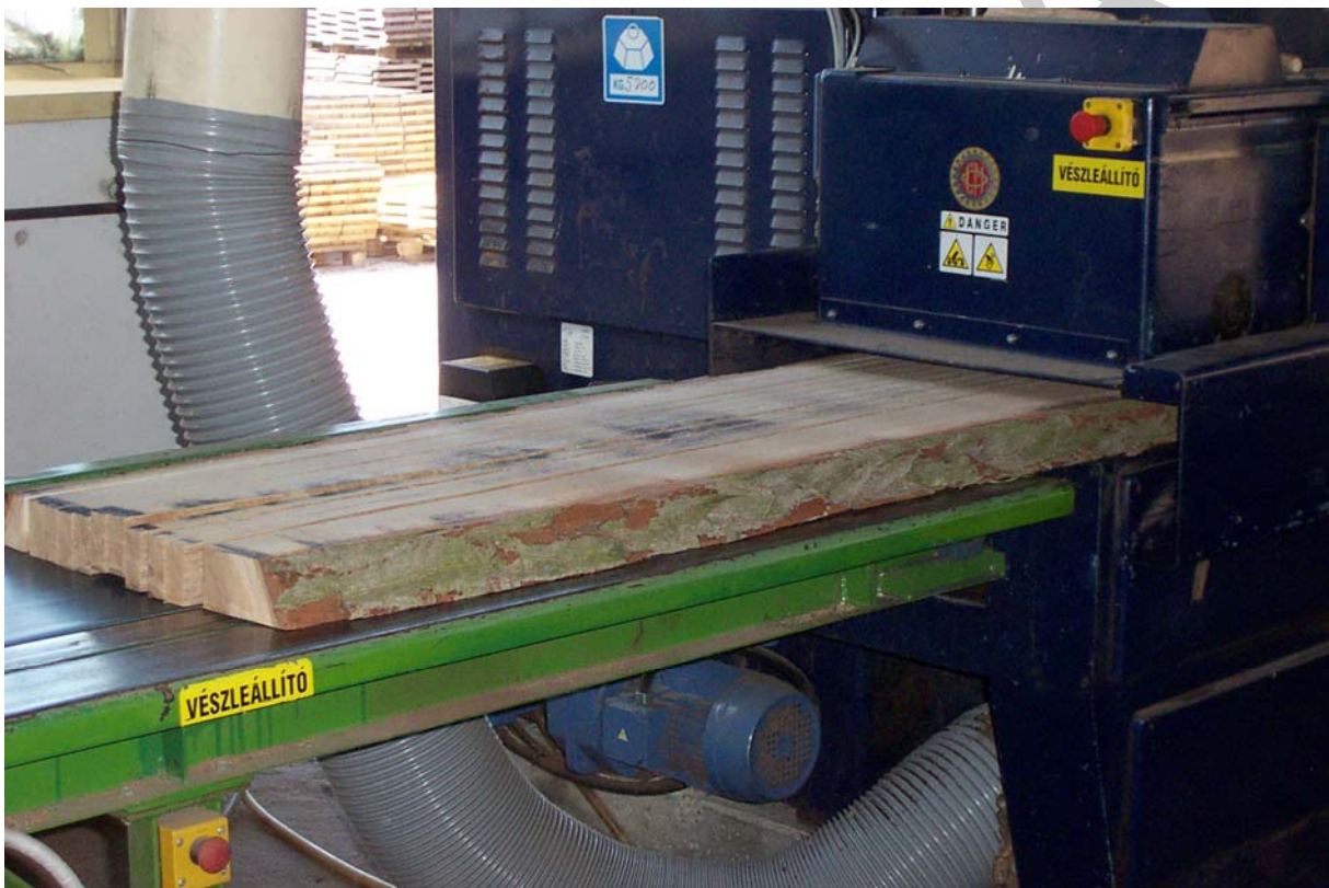
4. ábra. Parkettaléc termeléséhez palló visszavágása sorozatvágó körfűrészgépen
