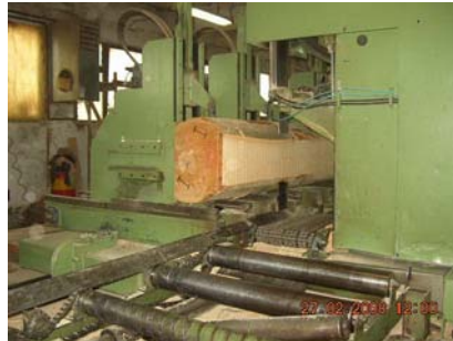
6. ábra. Prizma kialakítása rönkvágó szalagfűrészgépen
