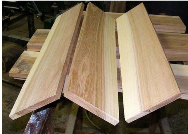
3. ábra. Szélesítő toldás előkészítése ragasztáshoz 3
