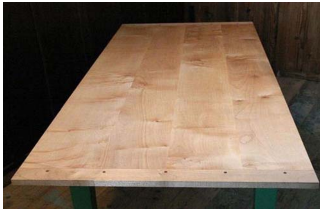
13. ábra Az angol típusú fejelőléc alkalmazása konyhaasztallapon 13
