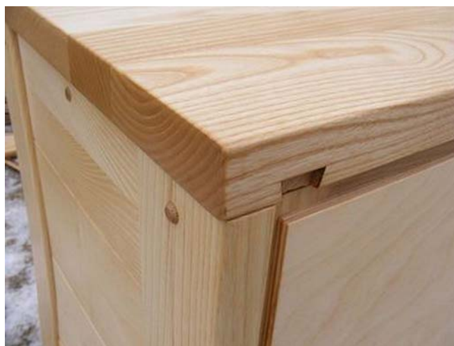
17. ábra. Elkészült hevederlécezés foltozás nélkül 17
