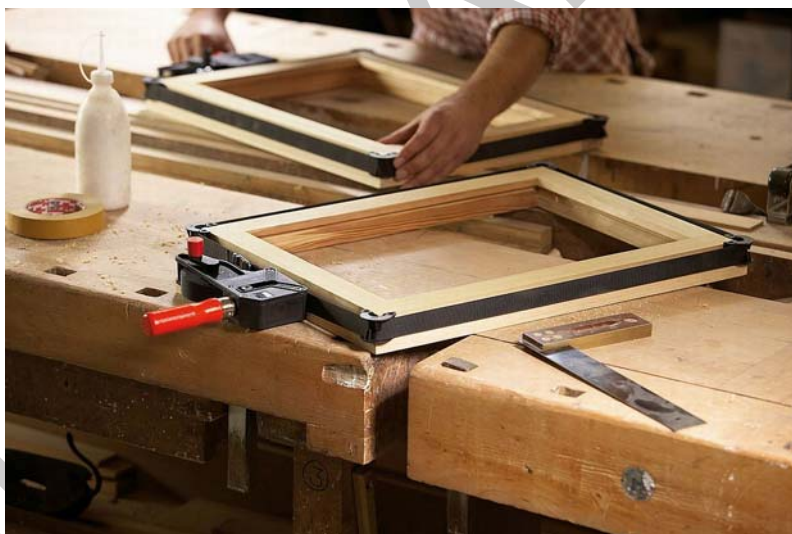
18. ábra. Keret szorítása szalagos szorítóval 18
