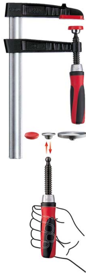
25. ábra. csavarorsós szorító, szorítópofája cserélhető betétekkel 25
