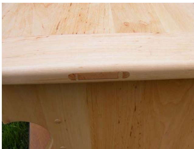
11. ábra. Padláda tetőlapja átmenő csapos ékelt fejelőléccel 11
