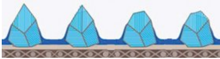
3. ábra. A csiszolóanyag felépítése 3
