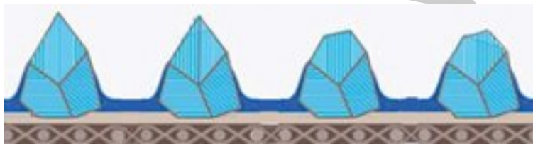
1. ábra. A csiszolóanyag felépítése 1
