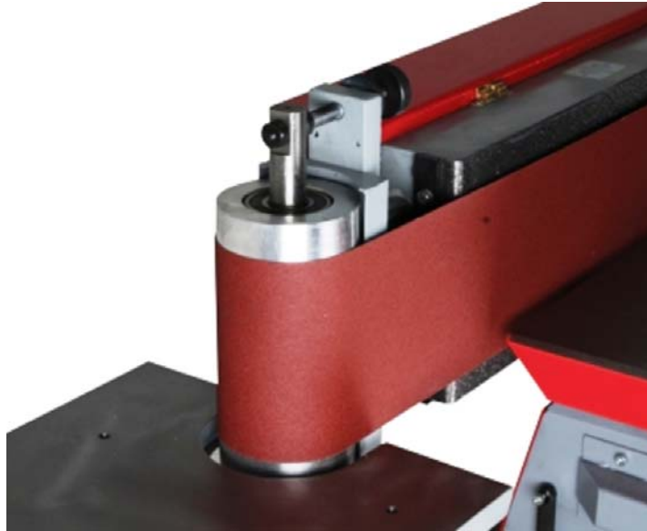
9. ábra Az 8. ábrán ismertetett élcsiszológép függőleges hengeréhez illesztett asztal, íves felületek csiszolásához 9
