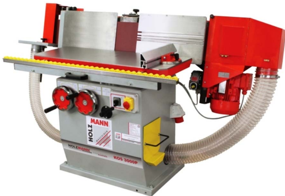
10. ábra Dönthető csiszológységű korszerű élcsiszológép 10
