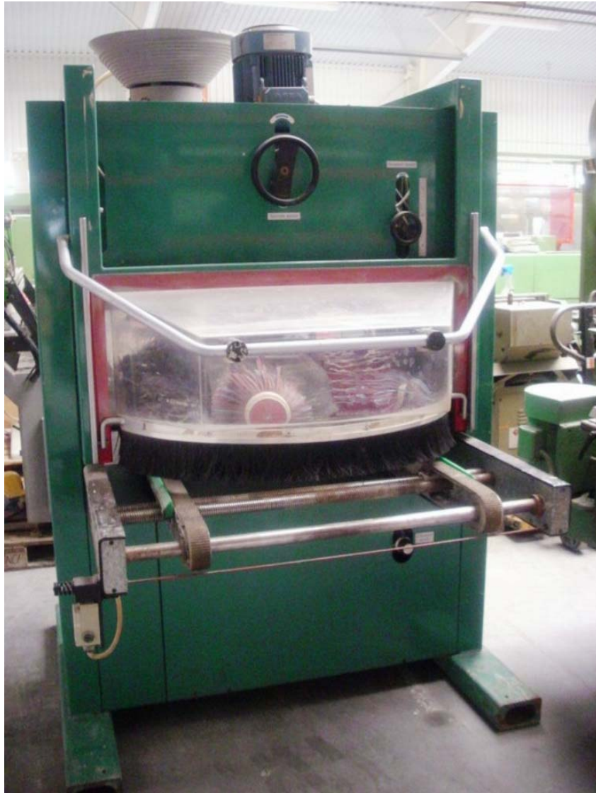
16. ábra Bolygó csiszolóegységes gép 16
