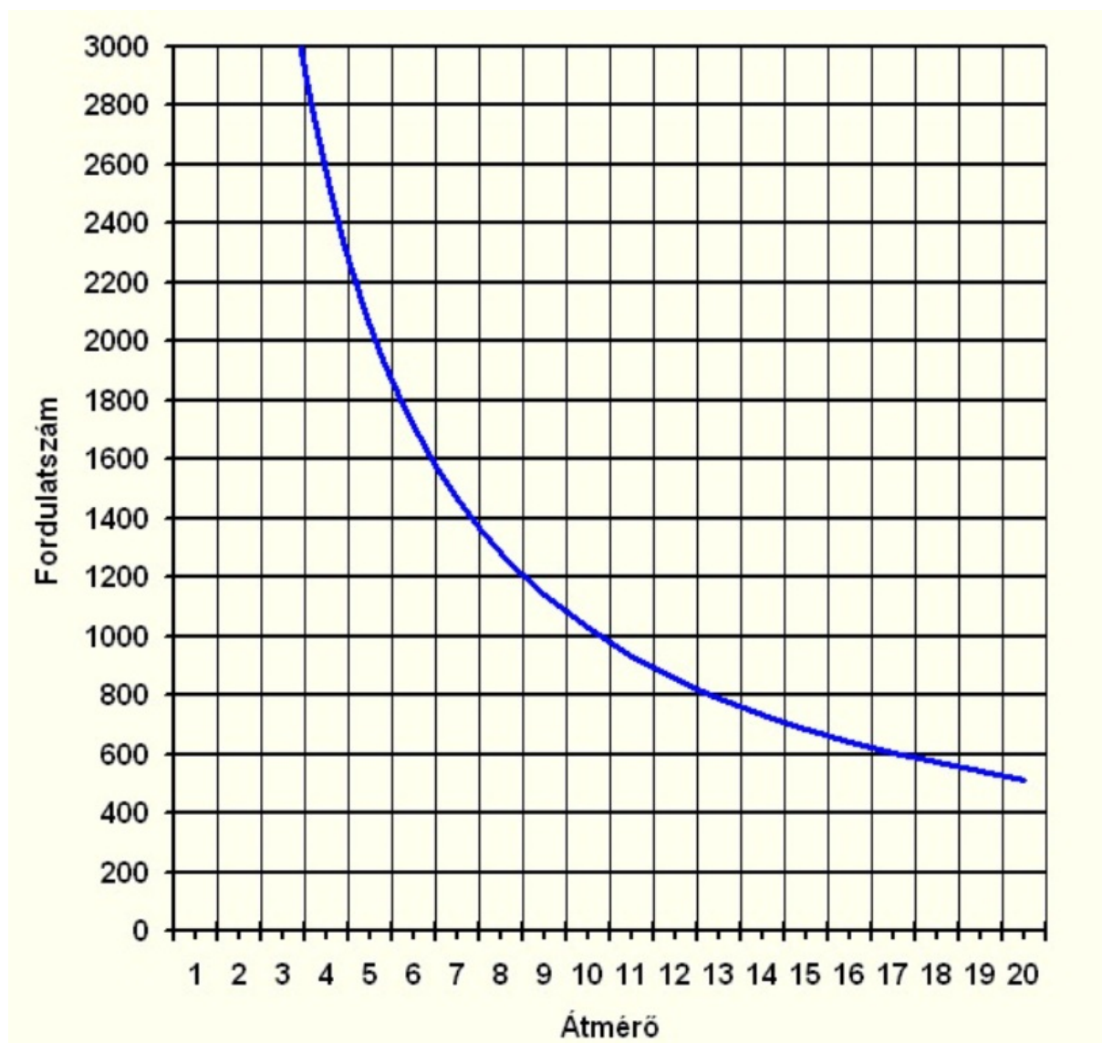
5. ábra. Javasolt fordulatszámok keményfához, fordulat/perc és átmérő (cm) függvényében 5
