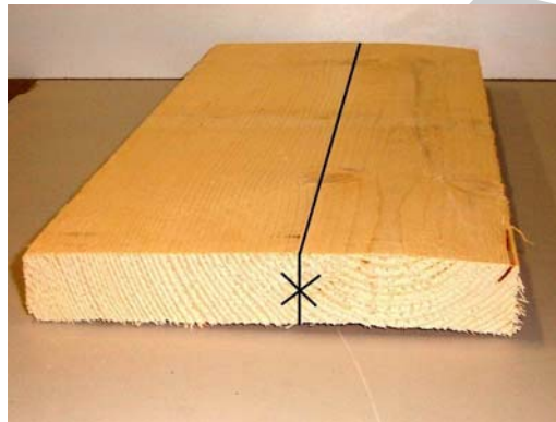
2. ábra. A széles fűrészáru a nedvességmozgás következtében deformálódik.
