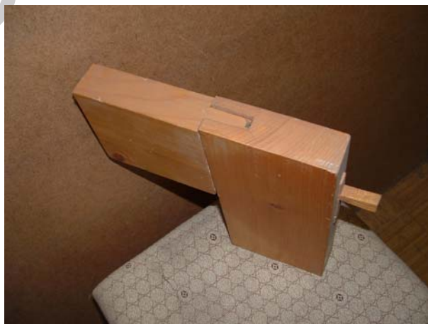
28. ábra. Szakálas vésett csap ékeléssel
