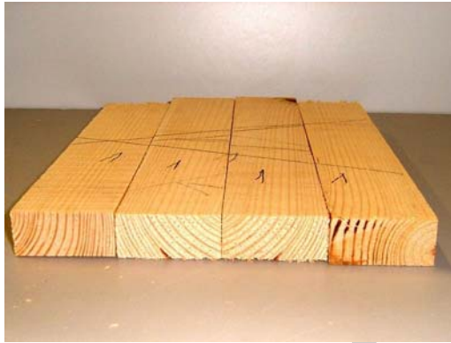
6. ábra. Sugármetszetű anyag összeforgatása
