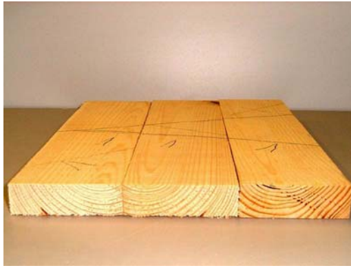
7. ábra. Húrmetszetű anyag összeforgatása
