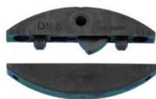
11. ábra. Kulccsal oldható esztétikus kötőelem üvegszál erősítésű műanyagból. Egyetlen látható eleme a záráshoz/oldáshoz szükséges 6 mm csavarfej. 0–180°-ig használható bármely szögben, bármely fához és fakompozithoz. Mérete: 66 x 29 x 8 mm 7
