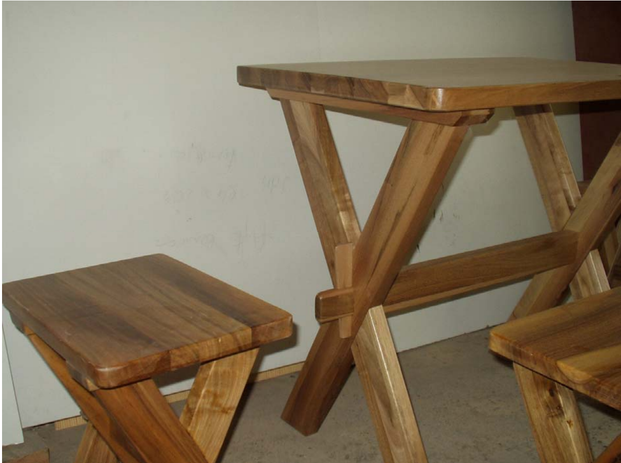
5. ábra. Rusztikus kivitelű asztal, a lábak összekötése ékkötéssel történt. 1
