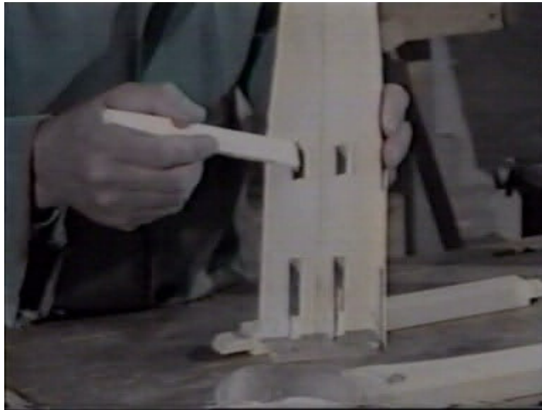
24. ábra. Csaprés megkenése ragasztóval 24
