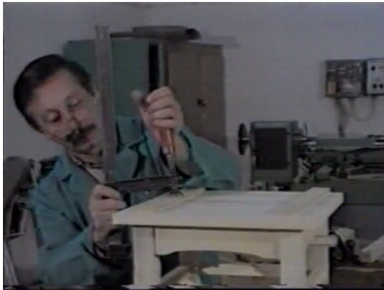
35. ábra. Ülőlap kávéra szorítása 35
