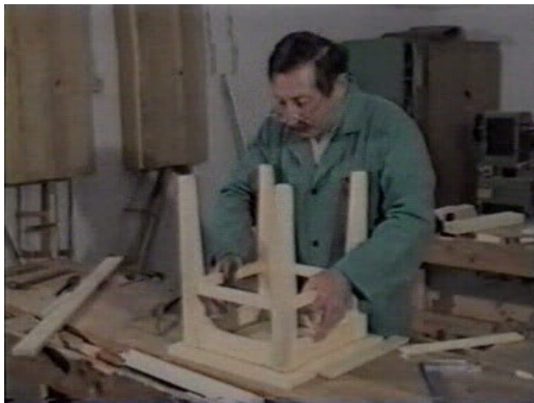
33. ábra. Köldökcsap helyének átjelölése az ülőlapra 33
