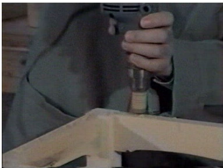
34. ábra. Köldökcsap helyének kifúrása pisztolyfúró géppel 34
