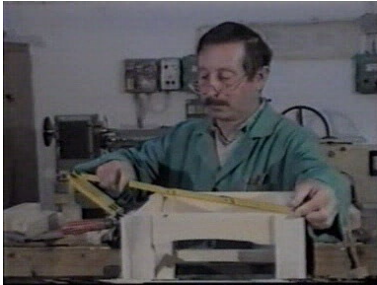
30. ábra. Derékszögesség ellenőrzése 30
