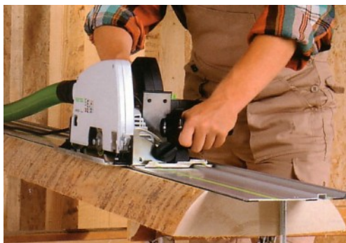
23. ábra. Szélezés kézi körfűrészgéppel 23
