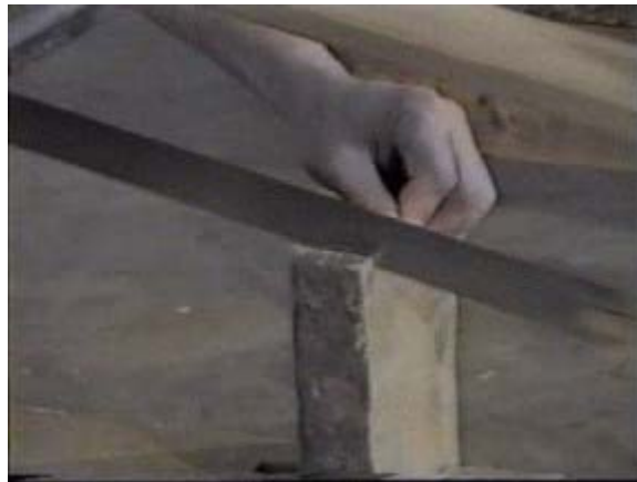
10. ábra. Fűrészáru szélezése 10
