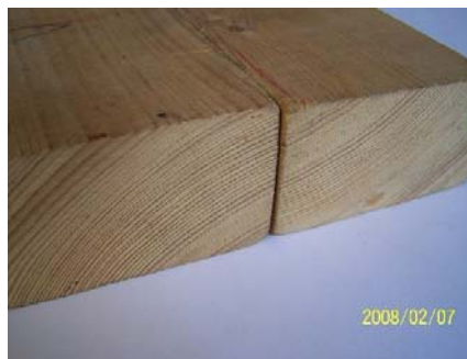
4. ábra. Húrmetszésű anyag váltott irányú összeforgatása 4
