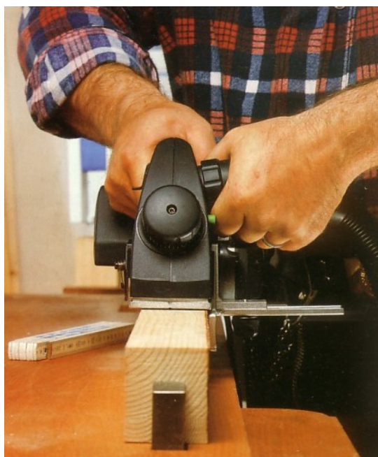
27. ábra. Élgyalulás elektromos kézi gyalugéppel 27
