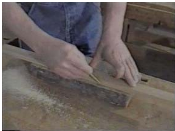
5. ábra. Fűrészáru berajzolása szélezéshez 5
