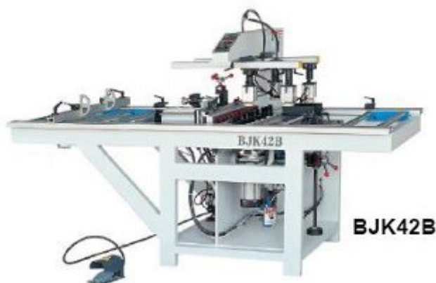
20. ábra. 42 orsós sorozatfúrógép 20
