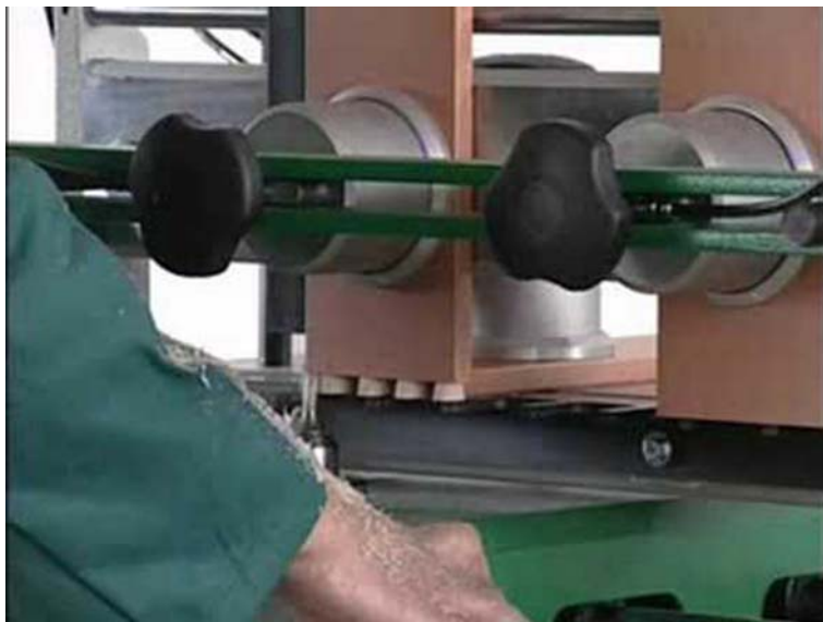
10. ábra. Alsó szerszámelrendezésű fogazó marógépen lekerekített fecskefark alakú fogazás készül.
