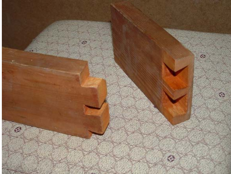
14. ábra. Kézi szerszámokkal készített félíg takart fecskefark alakú fogazás
