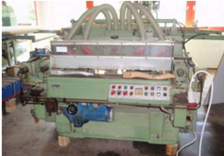
30. ábra. Karusszelasztalos másoló marógép(jellemzői:pneumatikus leszorítás, marófej 4KW ,szalagcsiszoló 2,2KW
