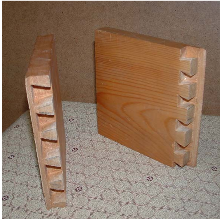
15. ábra. Kézi szerszámokkal készített takart fecskefark alakú fogazás
