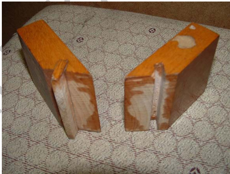
51. ábra. A sarokkötés készülhet idegen csappal. A csaprés kialakítása itt is történhet csapmaróval.
