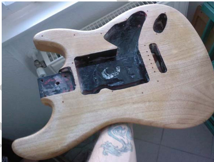
4. ábra. A CNC vezérlésű felsőmarokkal bonyolult összetett formák alakíthatóak ki. 5
