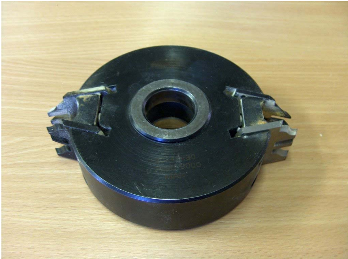
2. ábra. Feltűzhető, cserélhető élű marószerszám 2
