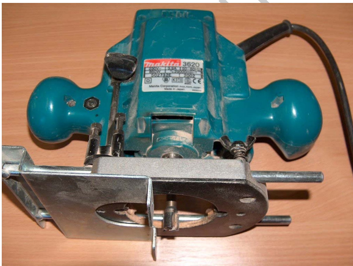
6. ábra. Kézi felsőmaró, vezetővonalzóval 6
