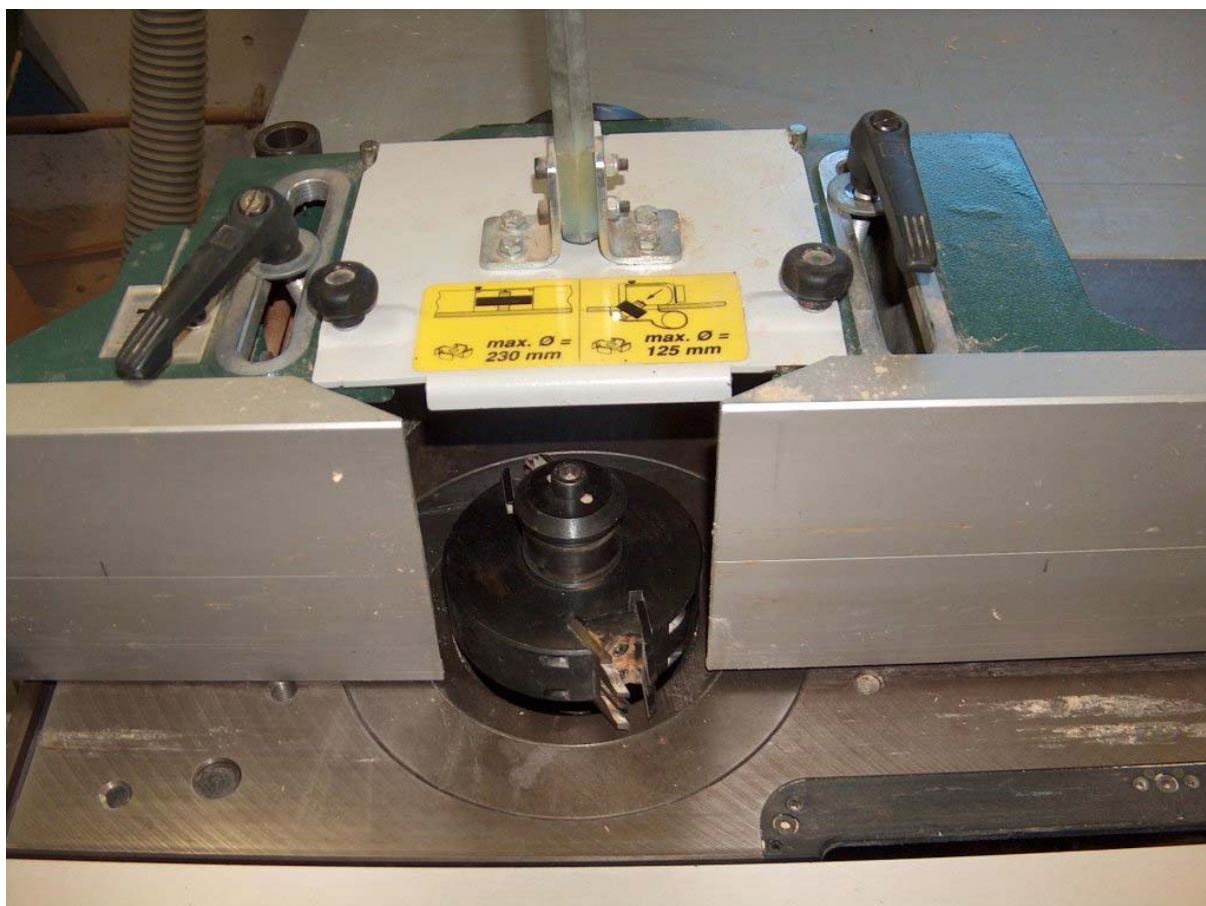
7. ábra. Asztalos marógép vezetővonalzója, alumíniumból 7
