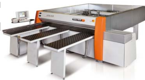
8. ábra. Holz-Her CUT 82 nyomógerendás lapszabásgép 6
