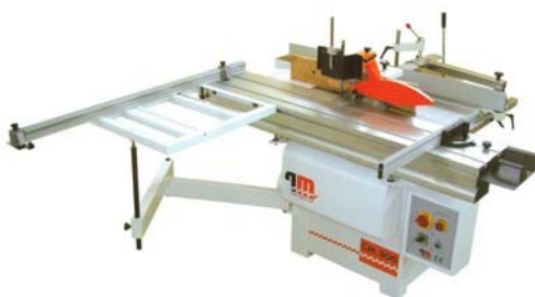
9. ábra. A körfűrészlapot felül védőburkolat takarja.
