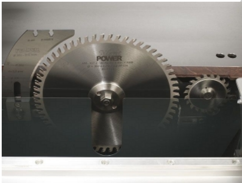
5. ábra. Az elővágó körfűrész az előtolással megegyező irányba forog, még az átvágást végző lap vele ellentétesen 4
