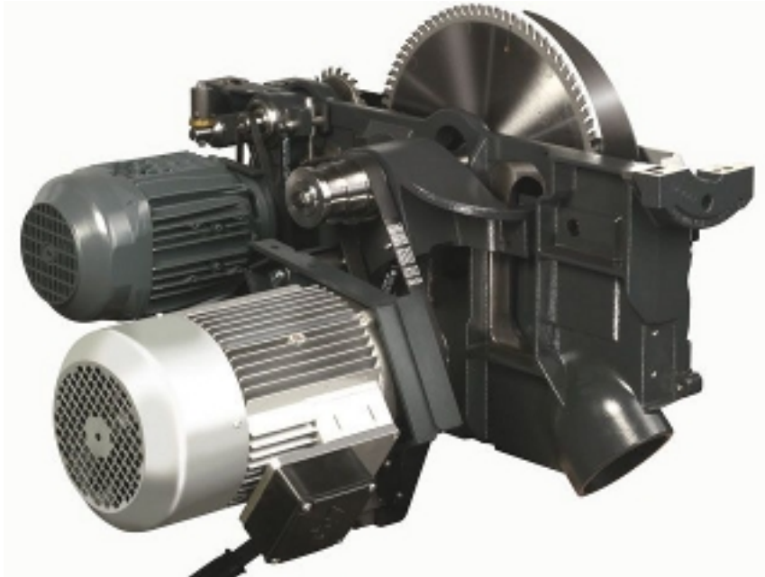
6. ábra. A körfűrészlapok duplán csapágyazott tengelyekkel forognak. A villanymotorokról az erőátvitel szíjhajtással történik.
