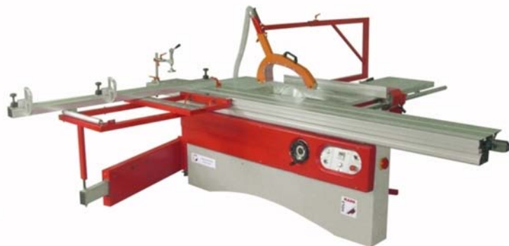
3. ábra Alsó tengelyelrendezésű egy irányba formatizáló kézi eltolású körfűrészgép 2
