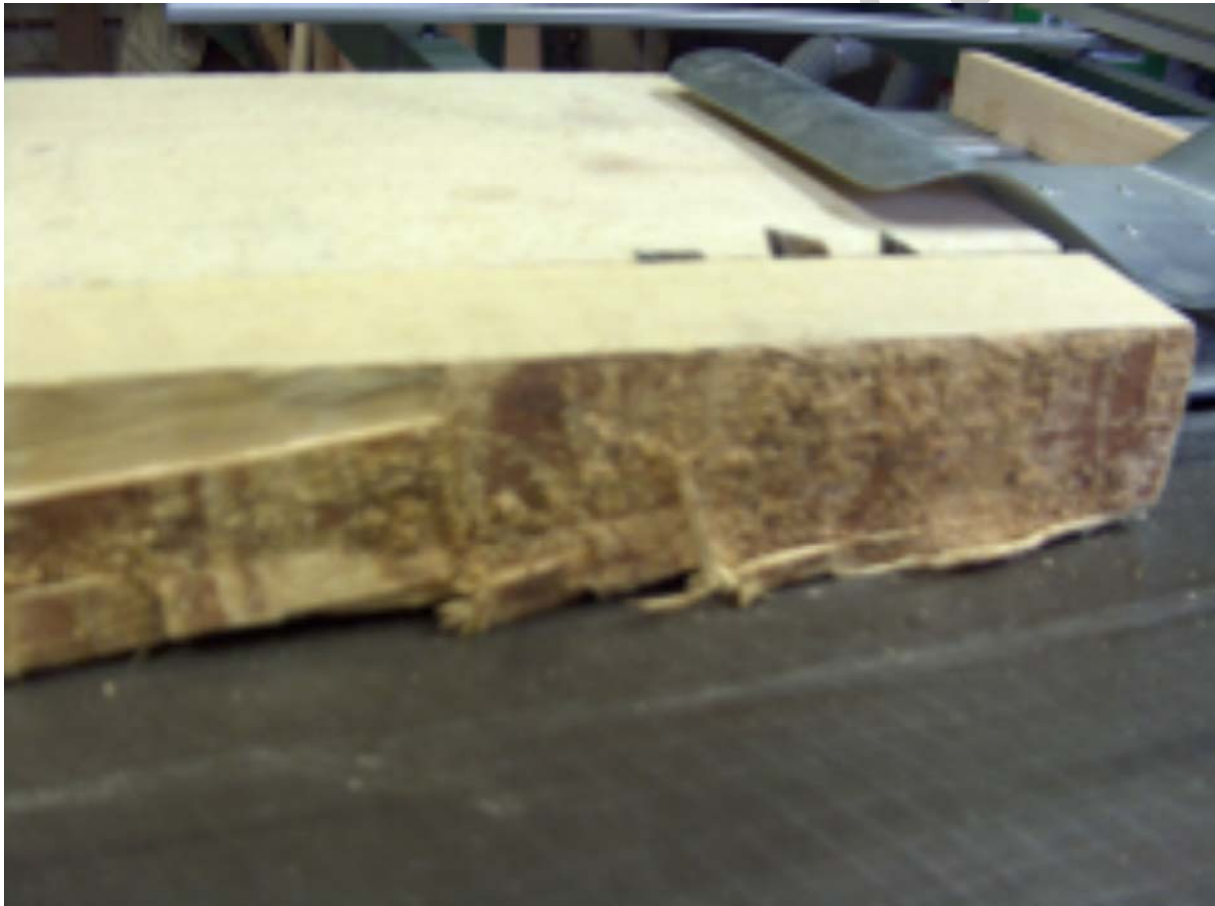
6. ábra. Szélezés. Kéregrészt eltávolítása, szélező papucssal 6
