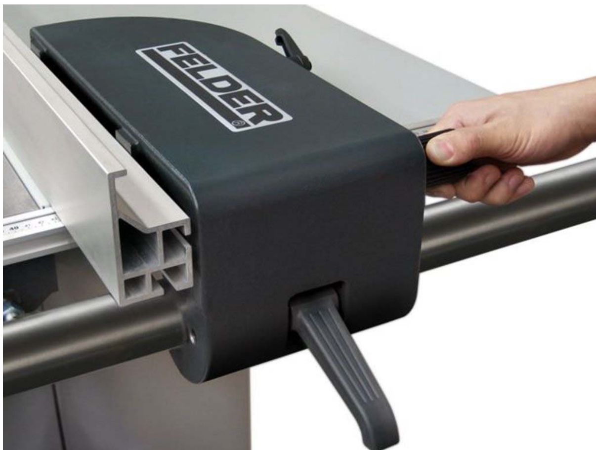
8. ábra. Vezetővonalzó gyorsrögzítője, finombeállítóval 8
