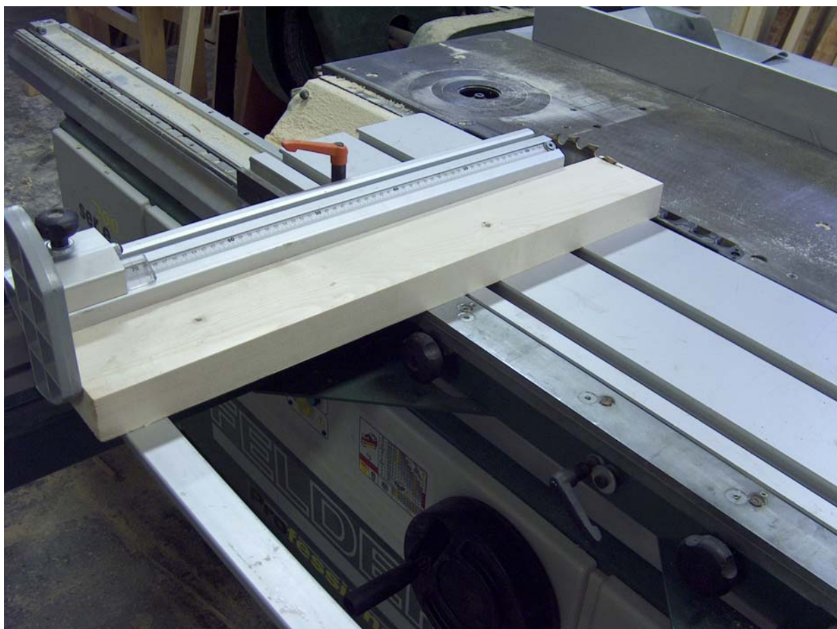
11. ábra. Darabolás, végütközővel 11
