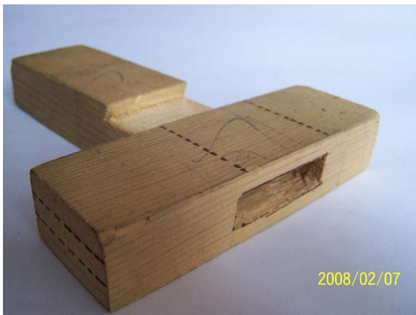
105. ábra. T-kötés átmenő vésett csappal
