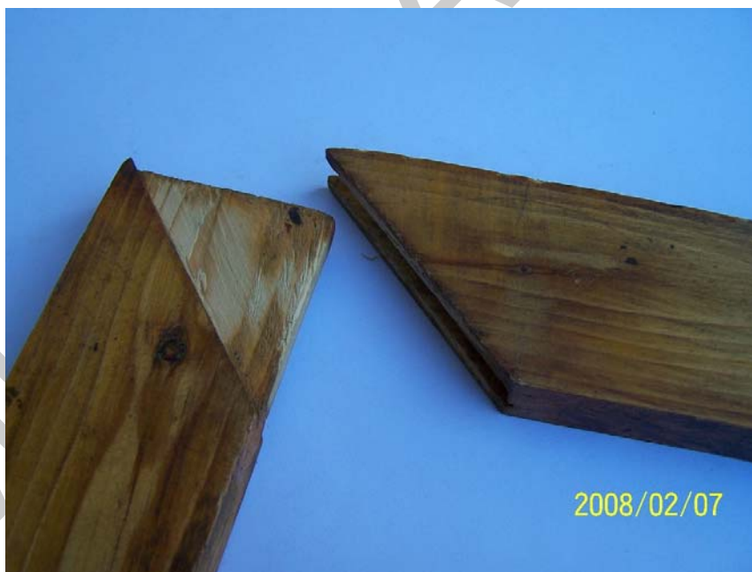
66. ábra. Ollós csapozás két oldalt 45°-os sarokillesztéssel 76
