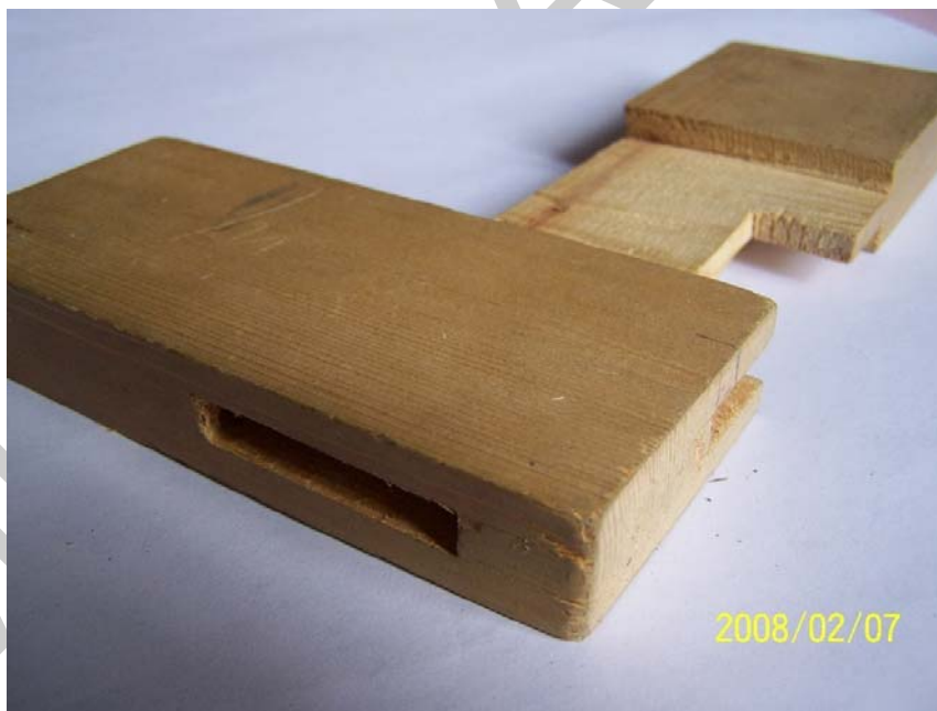
79. ábra. Átmenő szakállas vésett csapozás 89
