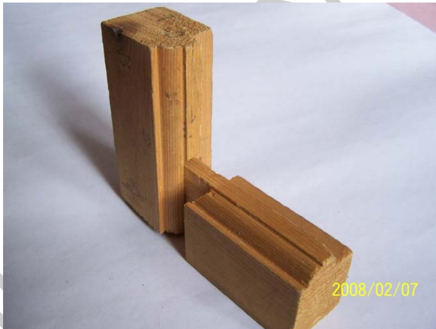
71. ábra. Ablakráma csapozása 81
