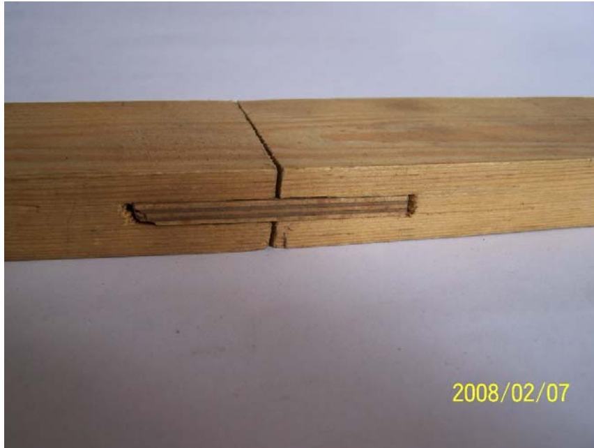
45. ábra. Idegencsapos toldás rétegelt-lemez csappal 55
