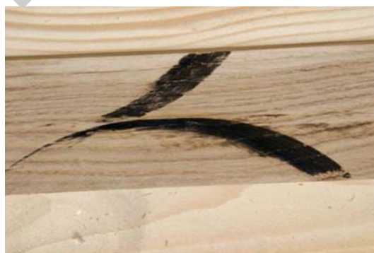
13. ábra. Forgácsoló szerszám okozta égésnyom 13
