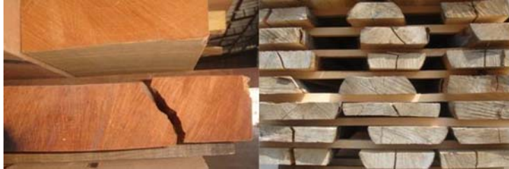
10. ábra. Szárítás gőzölés közben bekövetkezett bütürepedések 10
