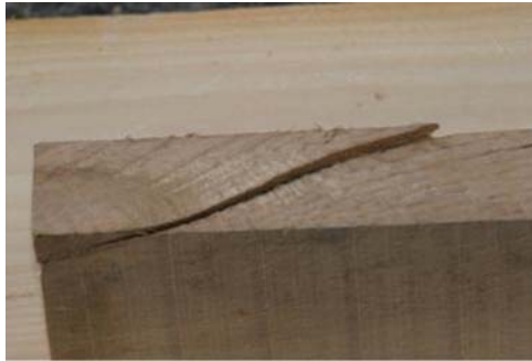
12. ábra. Megmunkálás során roncsolódott fűrészáru 12
