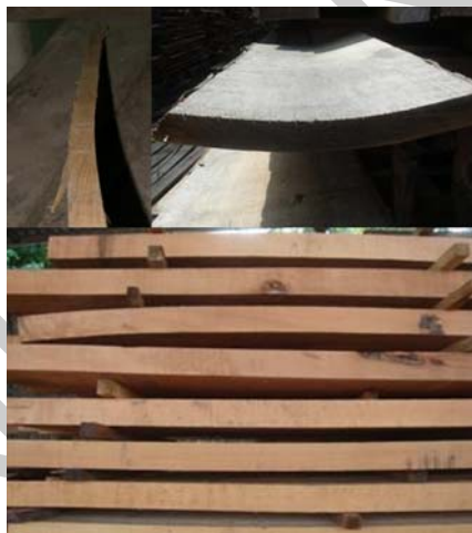
9. ábra. Fűrészáru szárítás közbeni vetemedése 9
