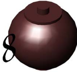
11. ábra. A láb esztergált gömb, vállal, és saját csappal
