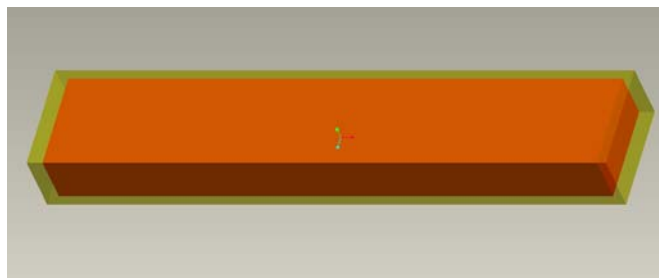
10. ábra. Pirossal a kész alkatrész befoglaló méretét, sárgával a túlmérettel megnövelt méretet ábrázoltuk.
