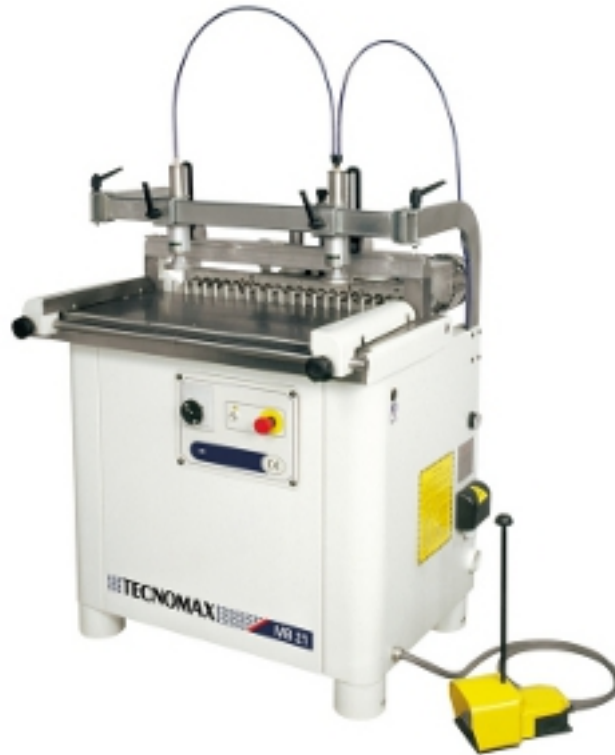
11. ábra. 21 orsós sorozatfúrógép 11
