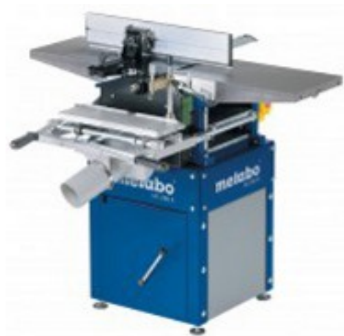
9. ábra. Gyalugéppel kombinált hosszlyukfúró gép 9
