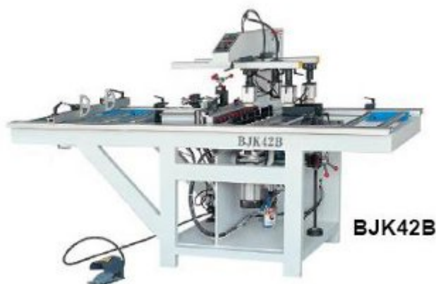
10. ábra. 42 orsós sorozatfúrógép 10
