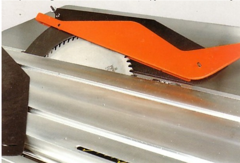
10. ábra. Védősisak önbeálló (ferde vágásnál) 3
