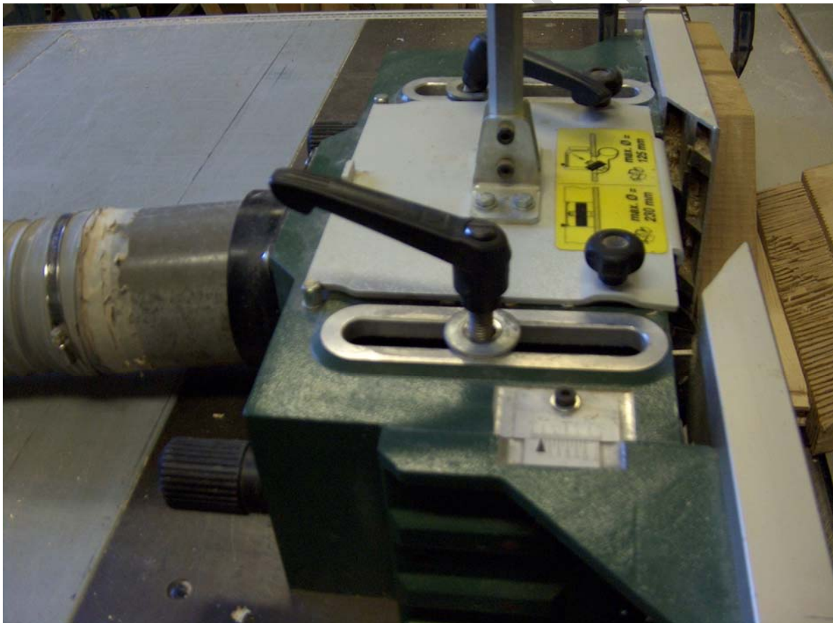
3. ábra. Marógép vezetővonalzójának állítási lehetősége 3
