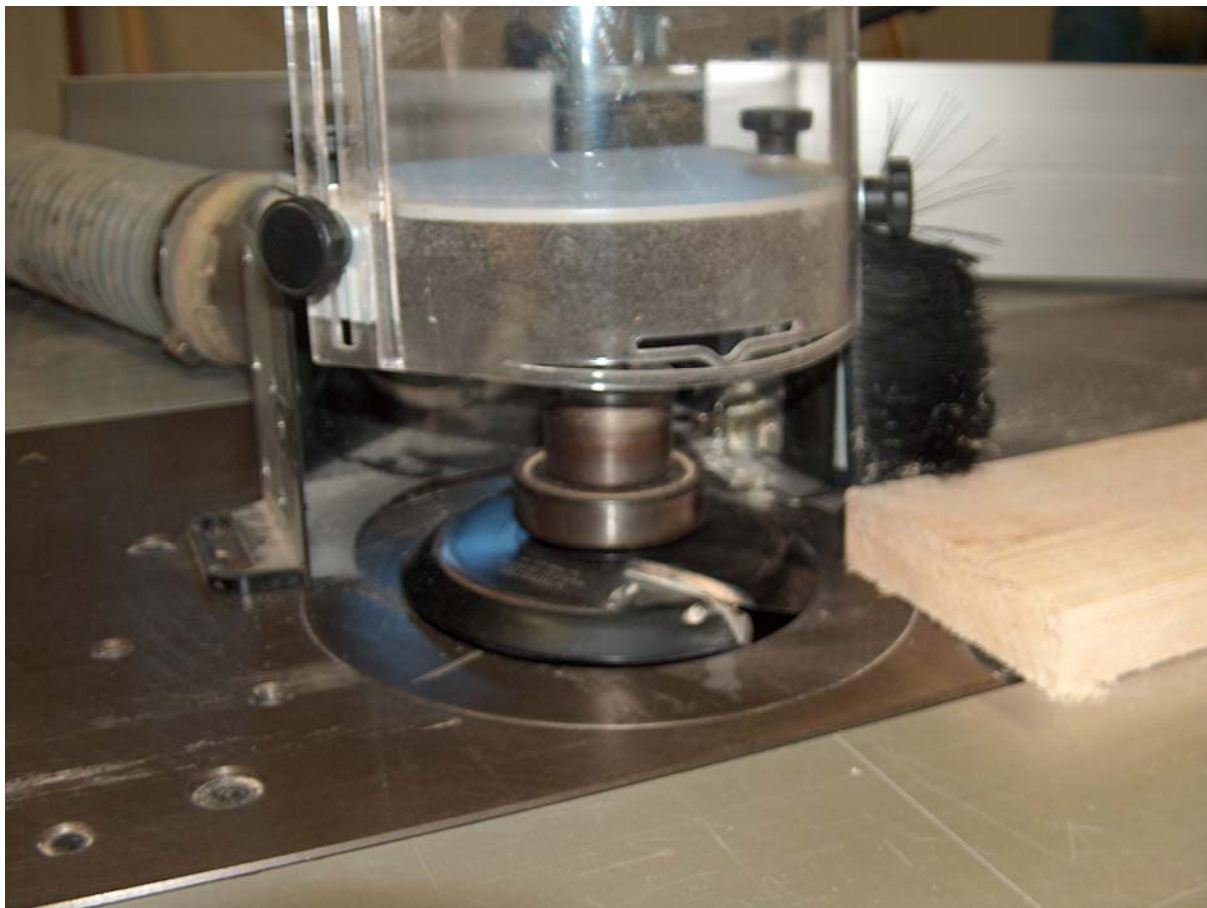
17. ábra. Csapágy melletti maráshoz a szerszám beállítása 17
