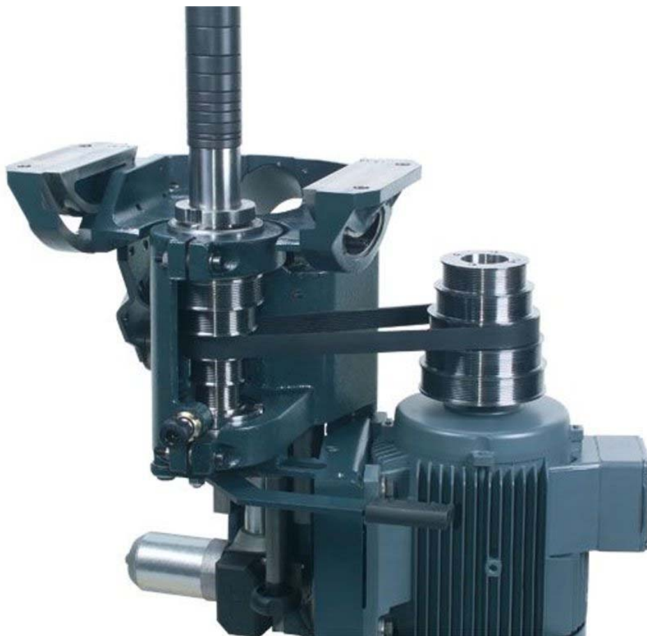
5. ábra. Meghajtómotor, lapos szíj hajtás, szerszámtartó orsó 5
