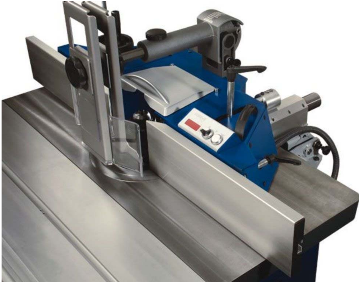
15. ábra Digitálisan állítható vezetővonalzó 15
