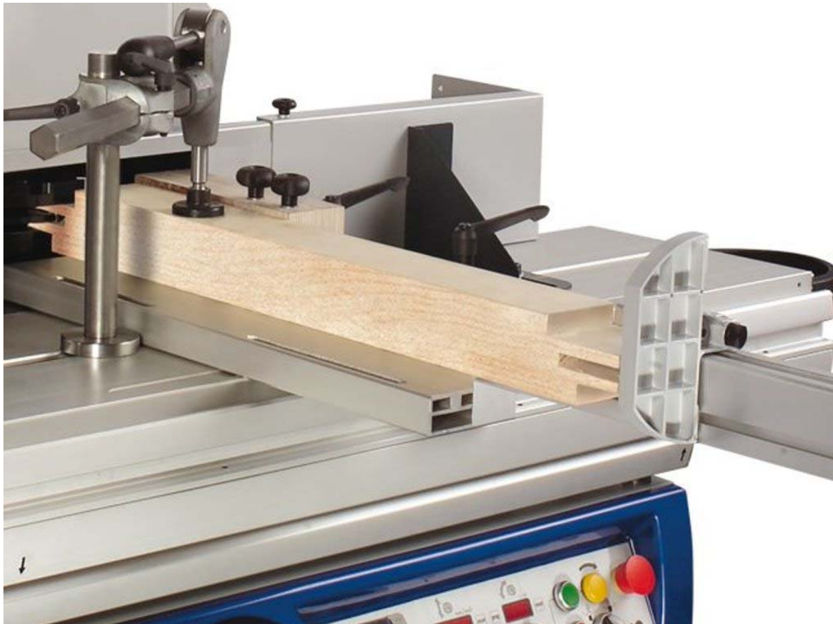
12. ábra. Csapozó asztal, excenteres leszorító 12
