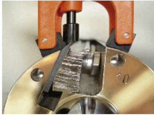
6. ábra. A gyalukés beállítása 6
