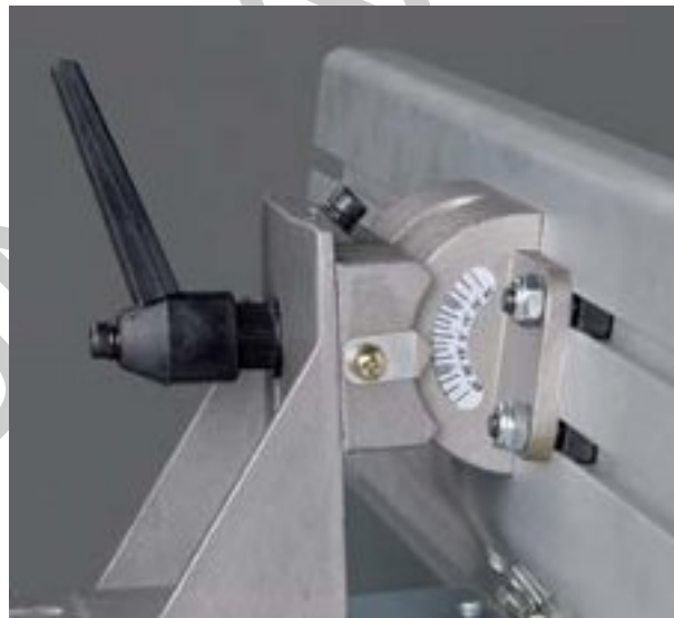
7. ábra. A vezetővonalzó dőlésszögének beállítása 7
