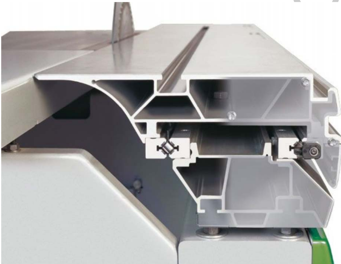
15. ábra. "X-roll" rendszerű toló asztal megvezetés 15
