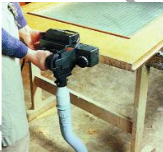
38. ábra. Kézi gyalugép használata elszívóval 38
