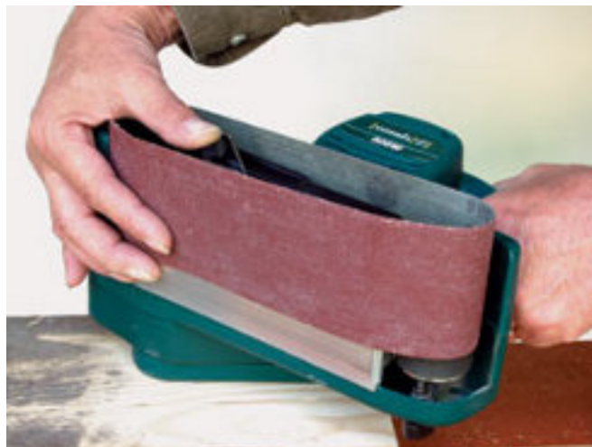
49. ábra. Szalagcsere kézi csiszológépen 49
