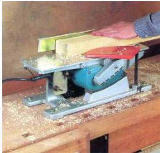
37. ábra. Egyengetés kézi gyalugéppel 37
