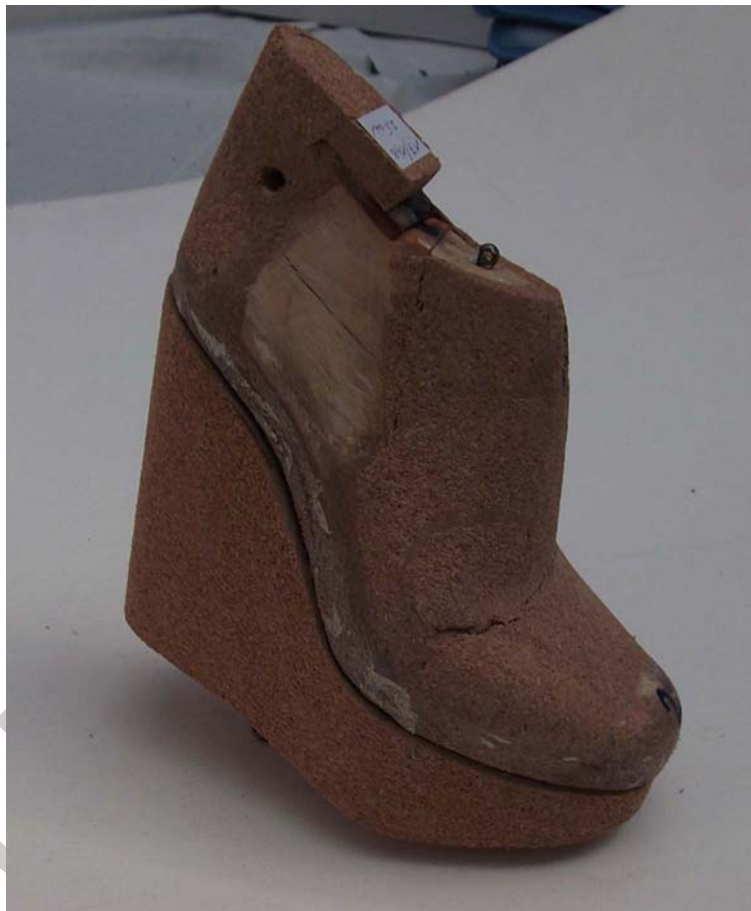
5. ábra. Átalakított kapta külső emeléssel
