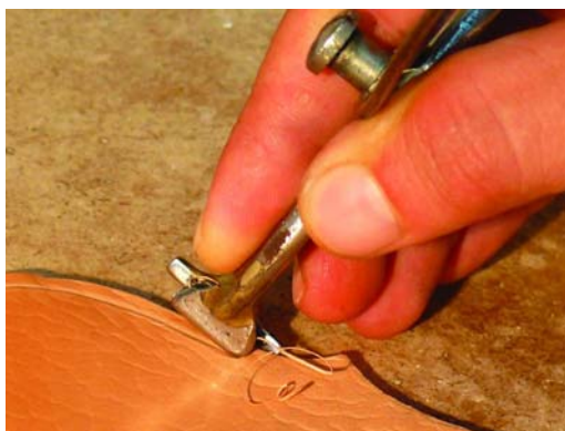
11. ábra. A szakítókörző használata
