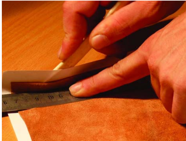
24. ábra. Behajtás – feltörés
