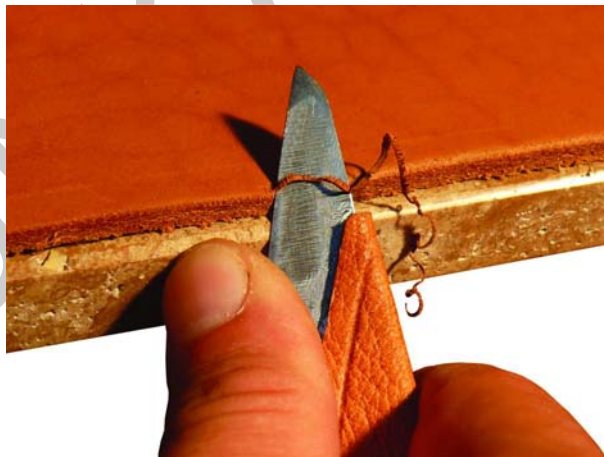
6. ábra. Élszedés késsel
