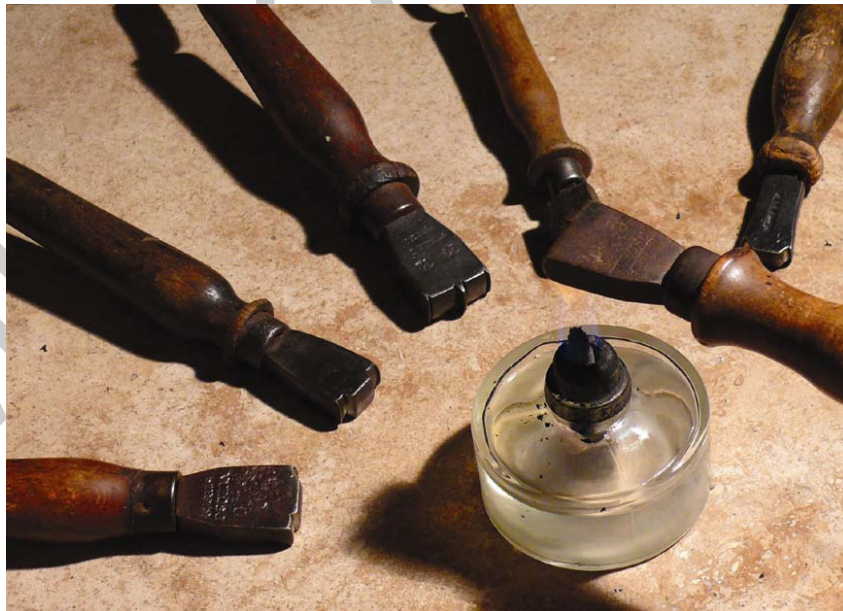
10. ábra. Szélezővasak melegítése
