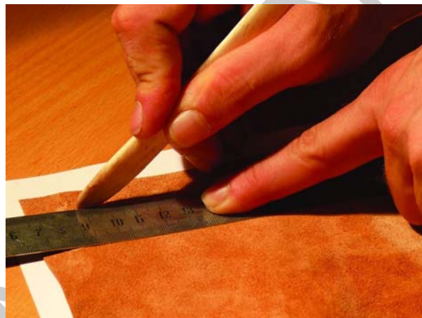
23. ábra. Behajtás – a hajtásvonal meghúzása
