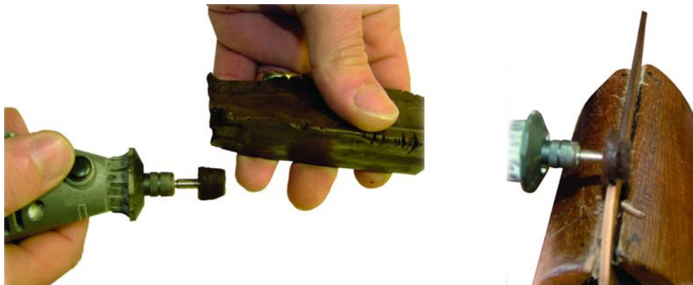
14. ábra. Szélviaszozás géppel
