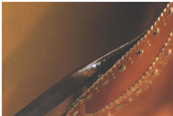
19. ábra. Paspólozás lyukasztott cakkozott szélű felsőrészen 4
