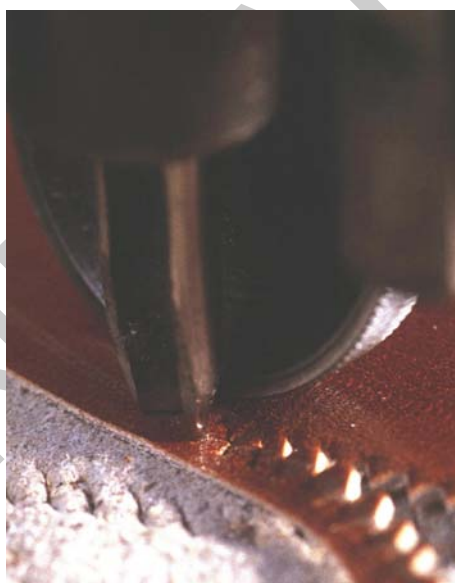
6. ábra. Cakkozás tűzőgépbe épített cakklyukasztóval 1
