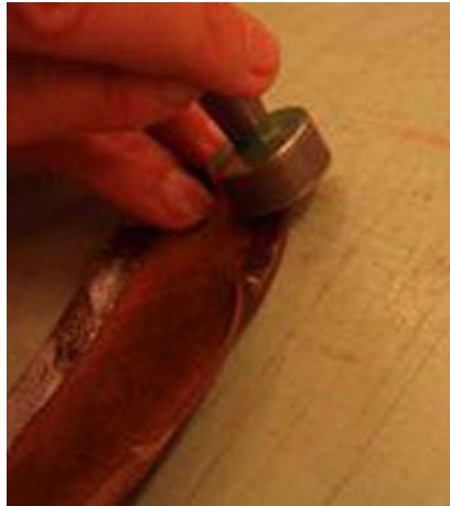
11. ábra. Szélbehajtásnál a behajtott szél lealapálása
