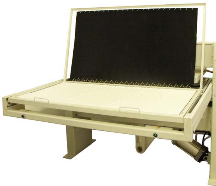
8. ábra. Sík prés gép, tálca kihúzva, felnyitva
