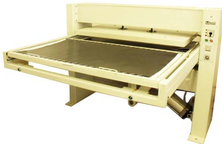
7. ábra. Sík prés gép, tálca kihúzva, lecsukva
