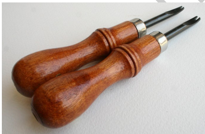
21. ábra. Élszedő szerszámok kétféle méretben
