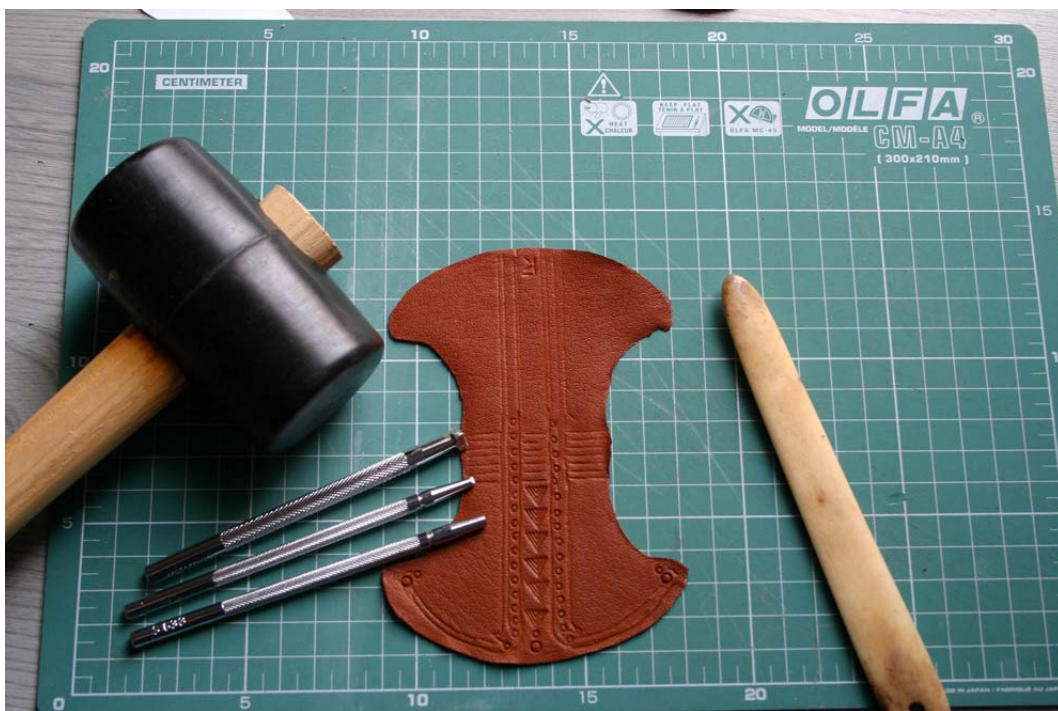
42. ábra. Díszítés a nedvesített alkatrészen csonttal, poncszerszámokkal
