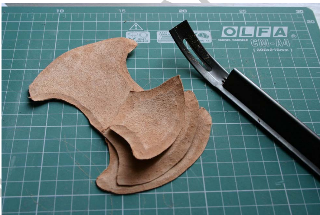
43. ábra. A külső és betét alkatrészek szélvékonyítása
