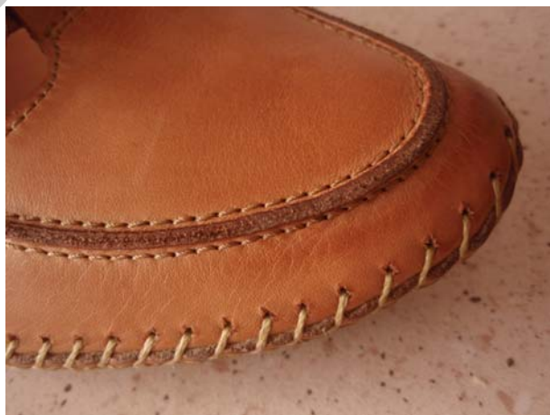
23. ábra. Párhuzamos és kézi varratot utánzó díszítések
