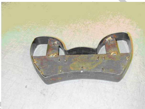
48. ábra. Szabázkésbe épített jelölőtűske
