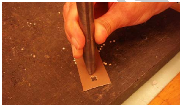
14. ábra. Díszlyukasztás kézi lyukasztóval
