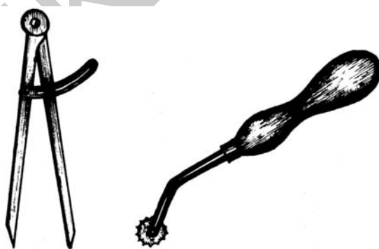
46. ábra. A kézi jelölésnél alkalmazott jelölőkörző és rádli (görgő) 19
