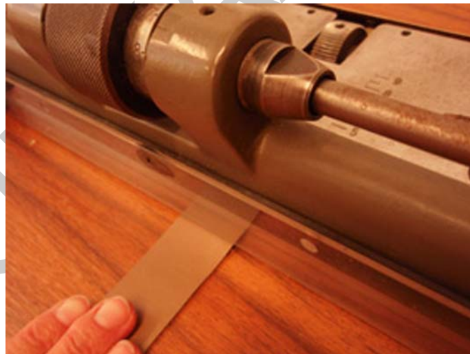
6. ábra. Alkatrész vékonyítása szalagkéses hasító gépen
