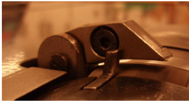
28. ábra. Nyomótalp beállítása párhuzamos élezéshez
