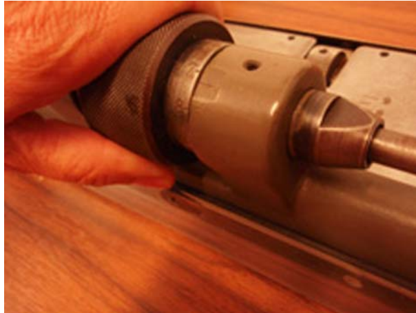
5. ábra Anyagvastagság beállítása állítóhenger segítségével
