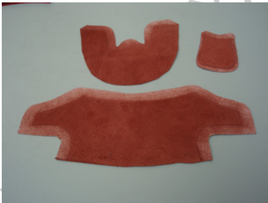
33. ábra. Szélvékonyított gyermek magas szárú cipő felsőrész alkatrészei
