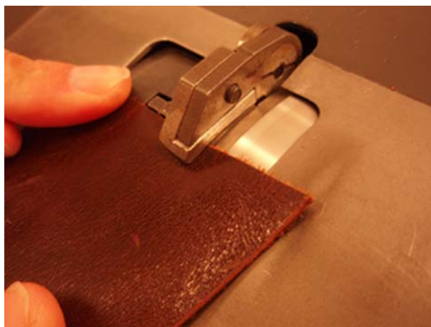
29. ábra. Alkatrész gépi élezése
