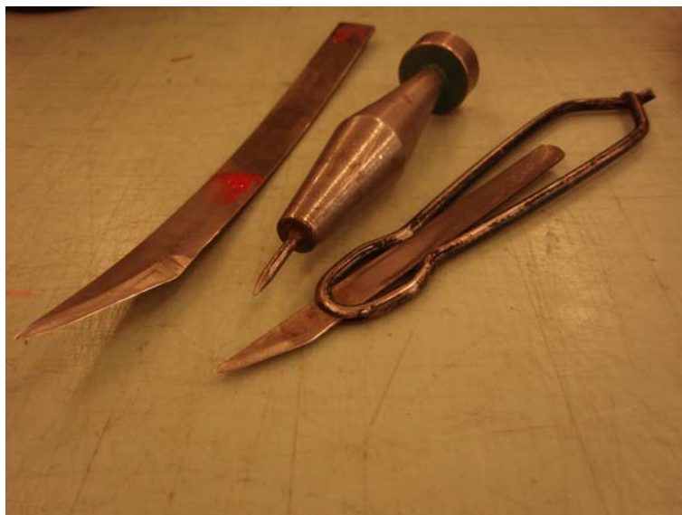
22. ábra. Vékonyító kések, jelölőár
