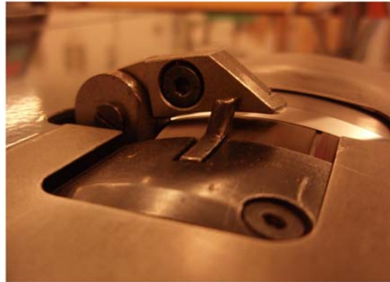
26. ábra. Élező gép munkavégző részei 1. harangkés, 2 továbbító görgő, 3 nyomótalp, 4. élezési szélességet beállító hátsó kitámasztó
