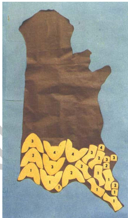
21. ábra. Váltakozó irányú szabásrendszer terve fél marhabőrön 7
