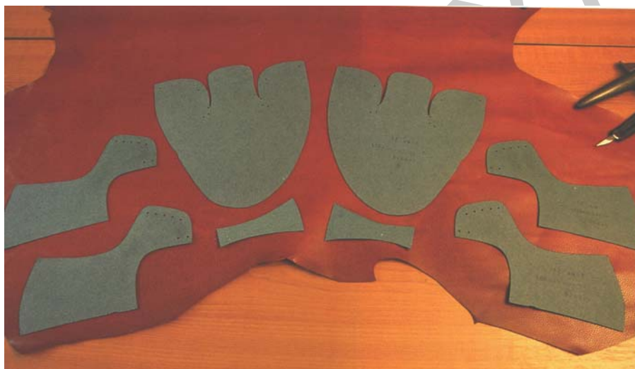
17. ábra. Derby felsőrész szabása páros szabásrendszerrel 5
