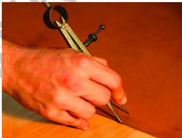
10. ábra. Párhuzamos jelölése jelölőkörzővel
