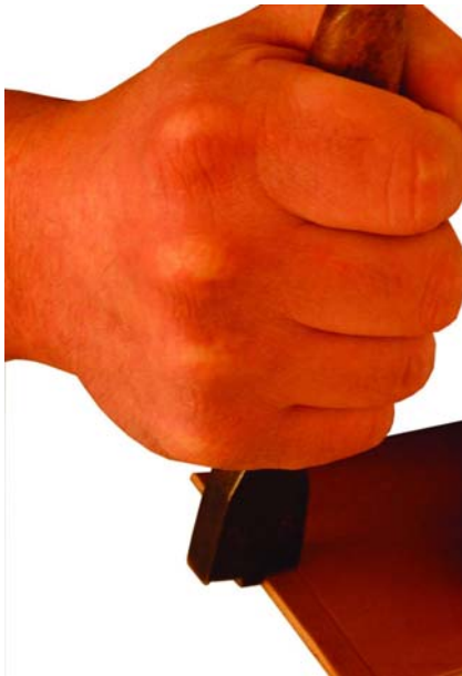
13. ábra. Párhuzamos húzása szélezővassal
