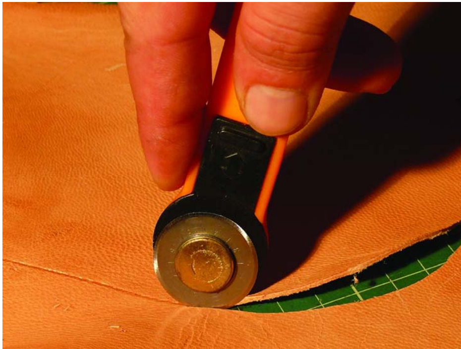
28. ábra. Ív szabása körpengés késsel
