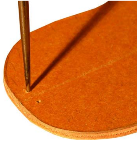
7. ábra. Pontok átjelölése árral karton jelölőmintán keresztül
