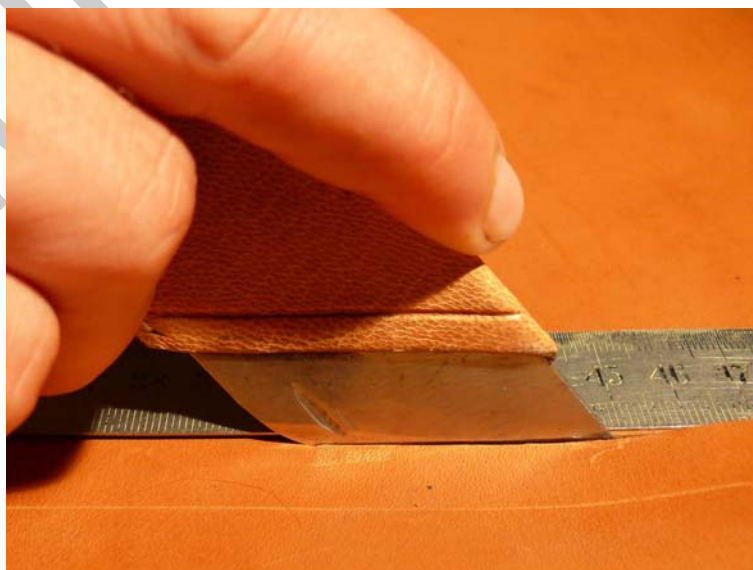
19. ábra. Egyenes szabása széles szabáskéssel
