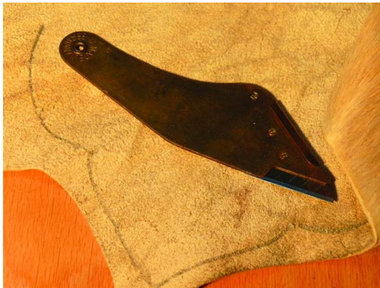
17. ábra. Szabásminta feljelölve a szőrme húsoldalára
