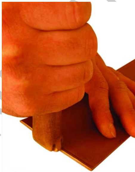
12. ábra. Párhuzamos húzása szélezőfával
