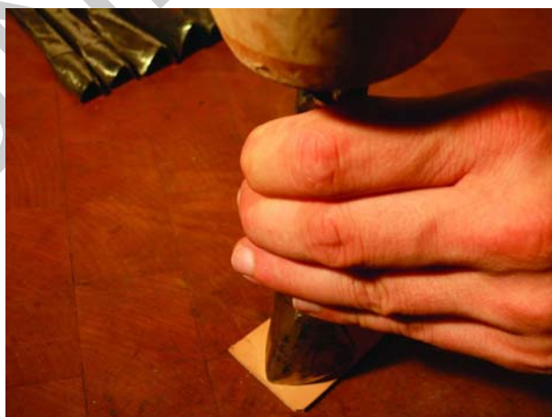
36. ábra. Szíjvég vágás kiütő szerszámmal
