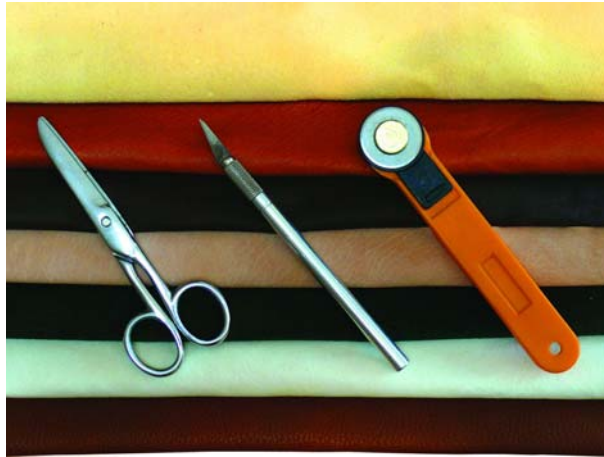
3. ábra. Vékony anyagok szabásához szükséges szerszámok
