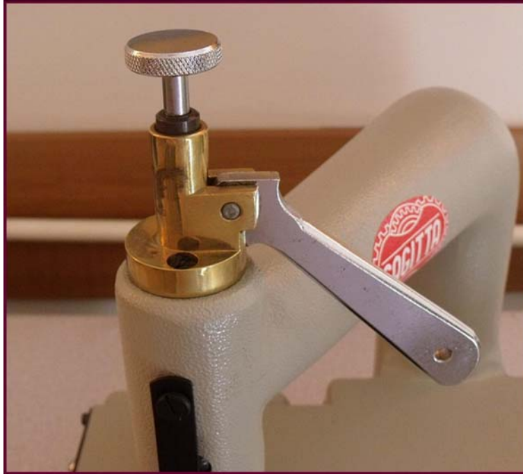
25. ábra. Anyagvastagság állító csavar és nyomótalp emelő
