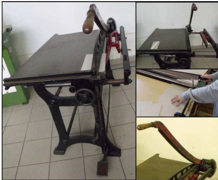
42. ábra. Karton darabolása lemezollóval
