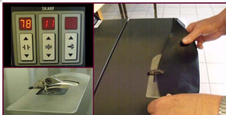
19. ábra. Szélvékonyítás lapos, mikroprocesszoros vezérlésű élezőgépen
