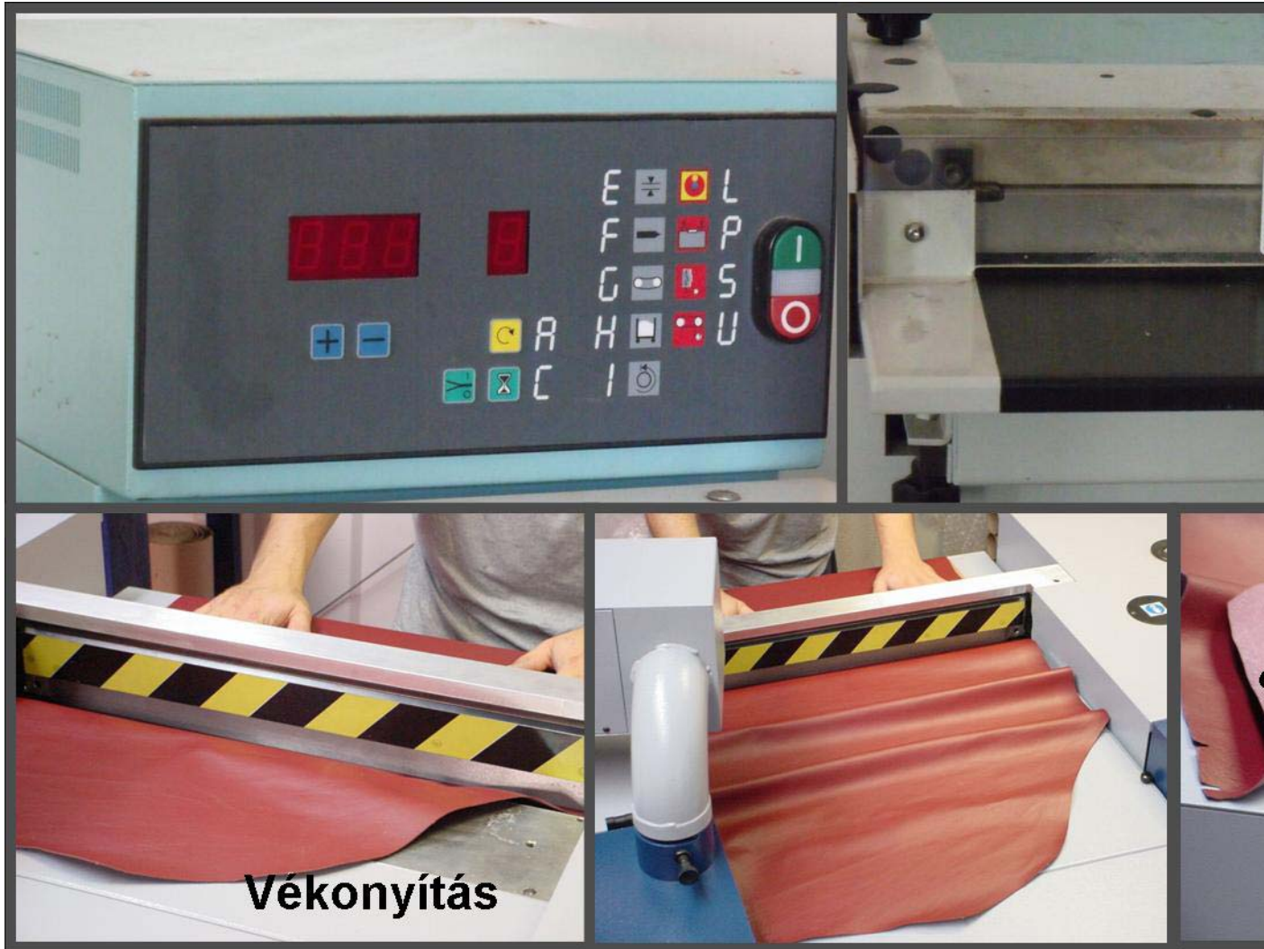
6. ábra. Teljes felületű vékonyítás
