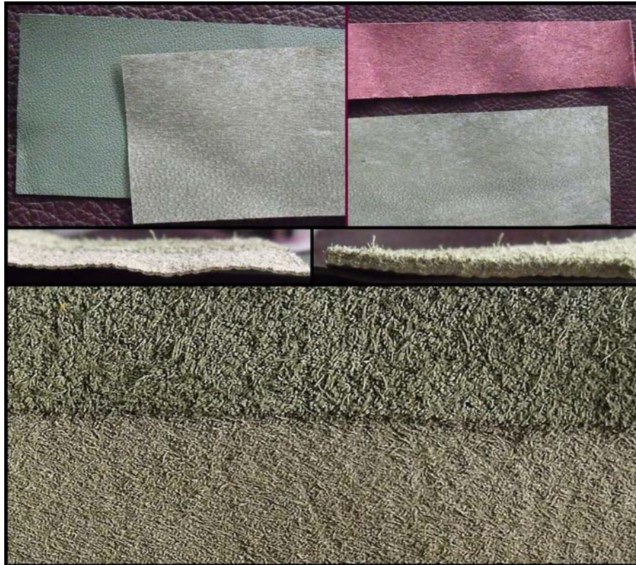
2. ábra. Teljes felületű vékonyítás a húsoldalon
