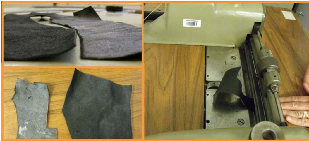
14. ábra. Teljes felületű vékonyítás
