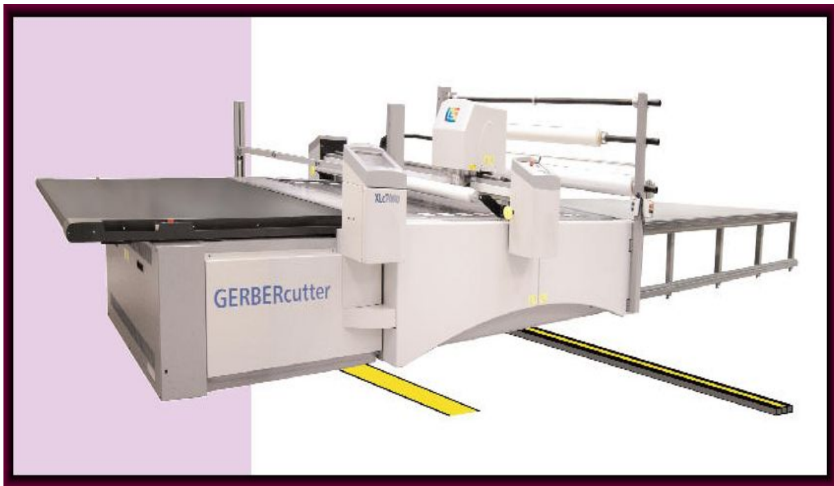
27. ábra. Számítógéppel vezérelt terítő és kivágó asztal 18
