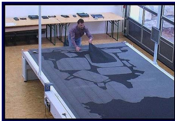
26. ábra. Számítógéppel vezérelt terítő és kivágó asztal (Gerber System) 17
