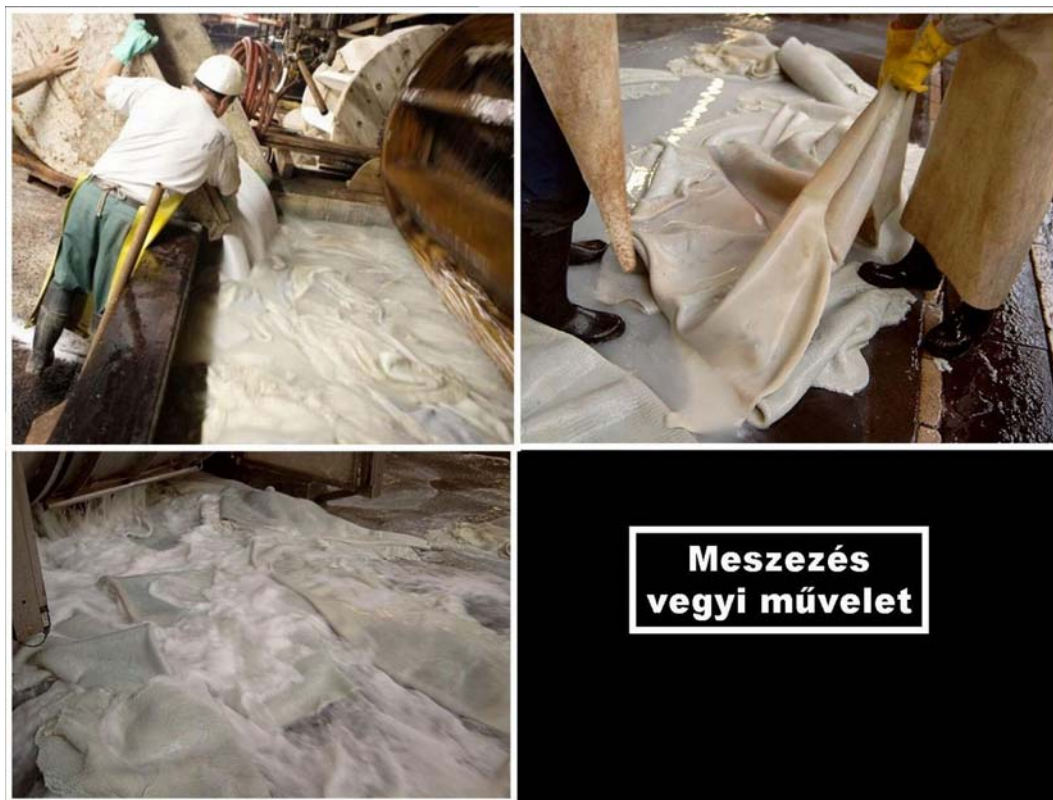
39. ábra. A meszezés vegyi művelete
