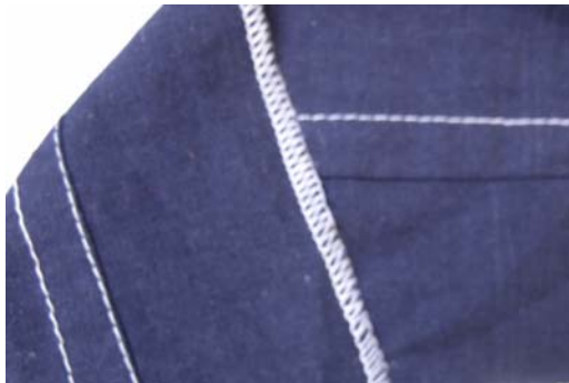
23. ábra. Bevágott zseb fonák oldala zsebvég erősítő alátétekkel 23
