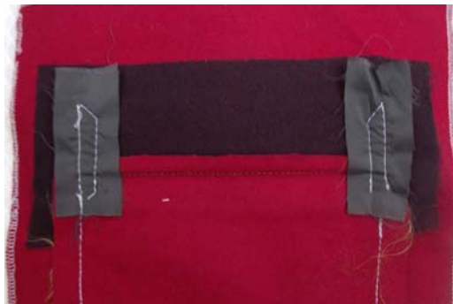
24. ábra. Húzózár bevarrása kétsoros tűzéssel 24
