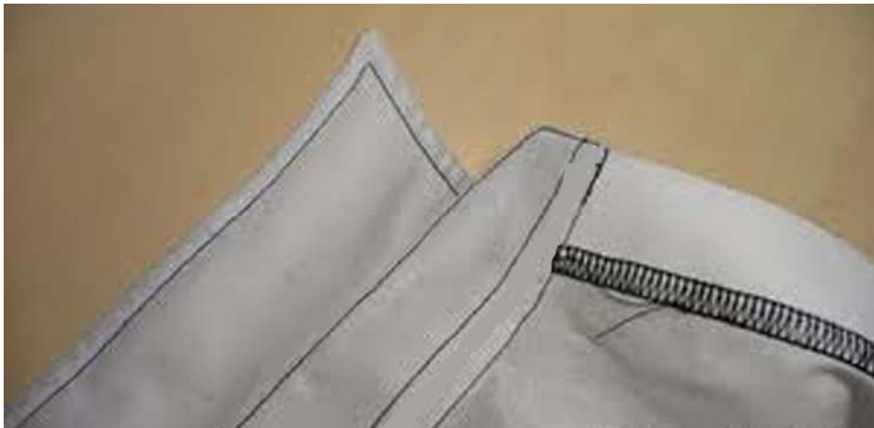
19. ábra. Előre tűzött inggallér felvarrás a nyakkörre 19
