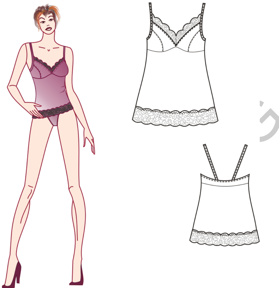
45. ábra. Mellrészes kombiné modell- és gyártmányrajza
