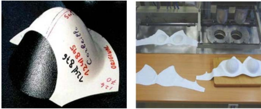
4. ábra. A mellrészek kialakítása hőprés-nyomógépen (Felina)
