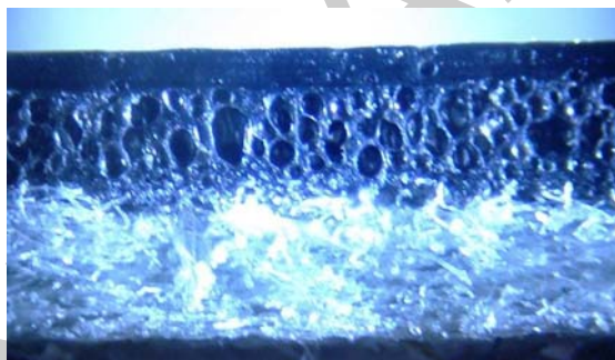
25. ábra A műbőr keresztmetszeti képe 23
