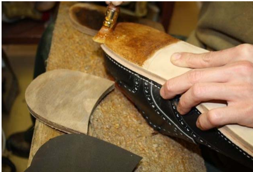
31. ábra. Folyékony ragasztó alkalmazása cipőkészítésnél 32
