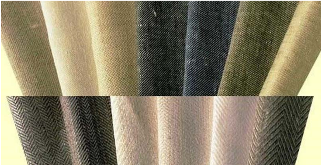
3. ábra. Sávolý alap- és halszálkás sávolýkötésű szövetek 3
